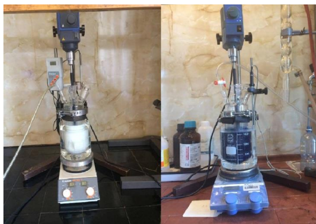
Slika 3.2. Polimerizacija PEDOT/TiO 2 na početku i nakon 96 h
