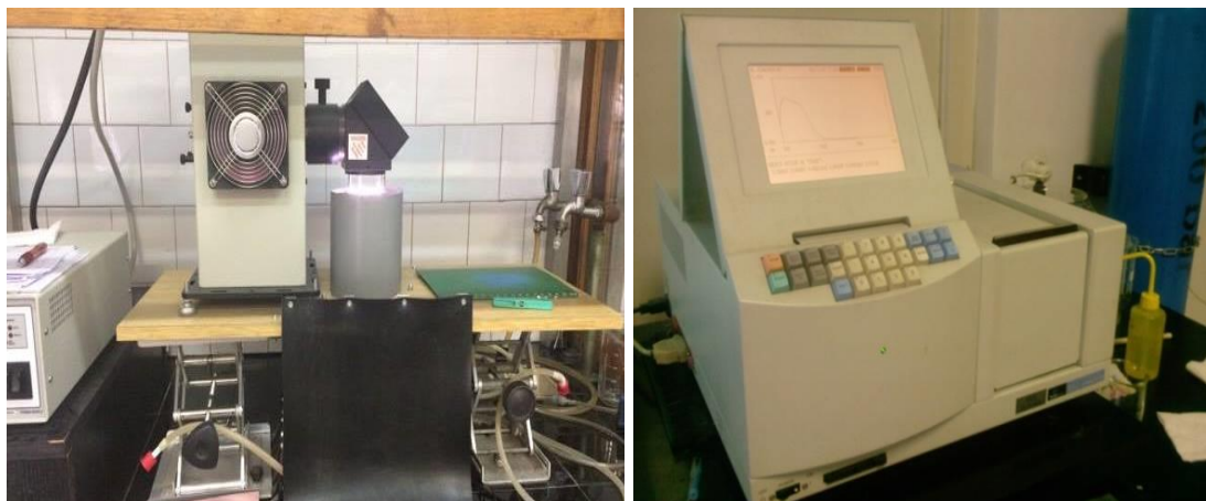
Slika 3.5. Simulator sunčevog zračenja, UV/Vis spektrometar Perkin Elmer Lambda EZ 201
