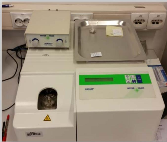
**Slika 3.5.** Fotografija diferencijalnog pretražnog kalorimetra (Zavod za inženjerstvo površina polimernih materijala, FKIT).
