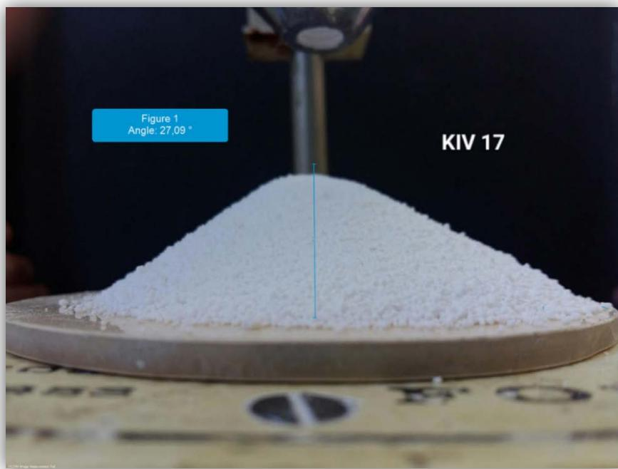
**Slika 4.8.** Fotografija formiranog stošca za granulat dobiven eksperimentom *BS-API*; primjena *KLONK Image Measurement* softverskog paketa u određivanju kuta mirovanja.
