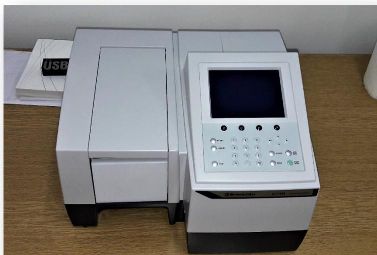
**Slika 3.8.** Fotografija spektrofotometra UV-1280 (Shimadzu, Kyoto, Japan).
