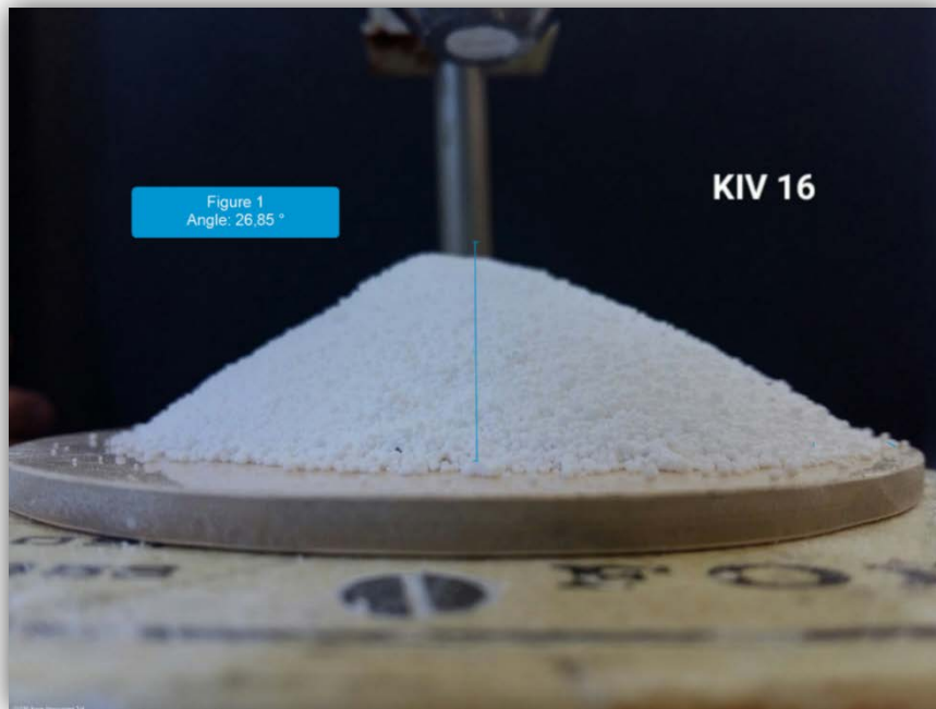
Slika 4.7. Fotografija formiranog stošca za granulat dobiven eksperimentom TS-API ; primjena KLONK Image Measurement softverskog paketa u određivanju kuta mirovanja.
