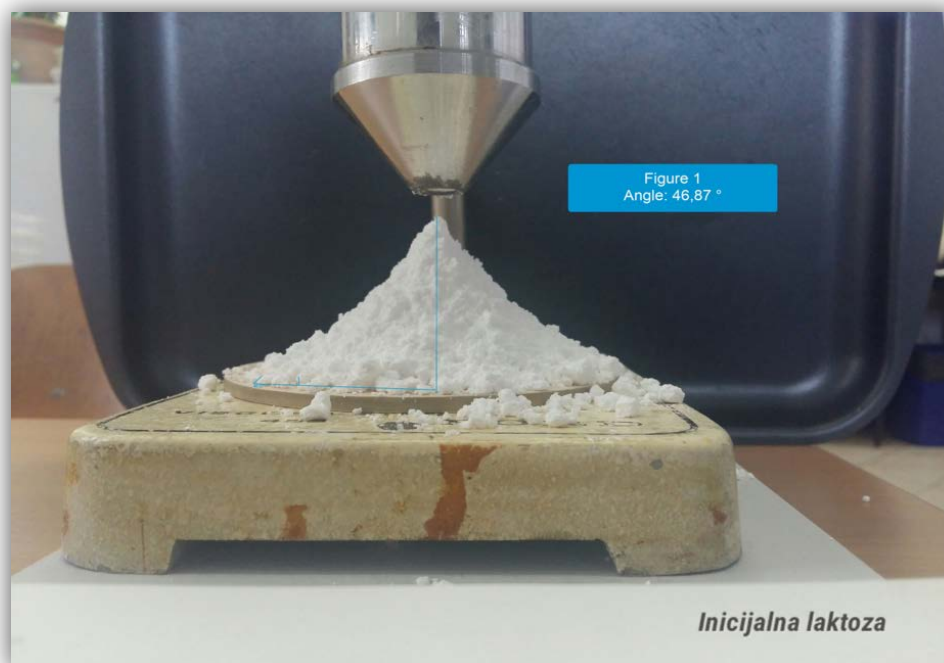
Slika 3.14. Fotografija formiranog stošca za inicijalnu laktozu monohidrat; primjena KLONK Image Measurement softverskog paketa pri određivanju kuta mirovanja.
