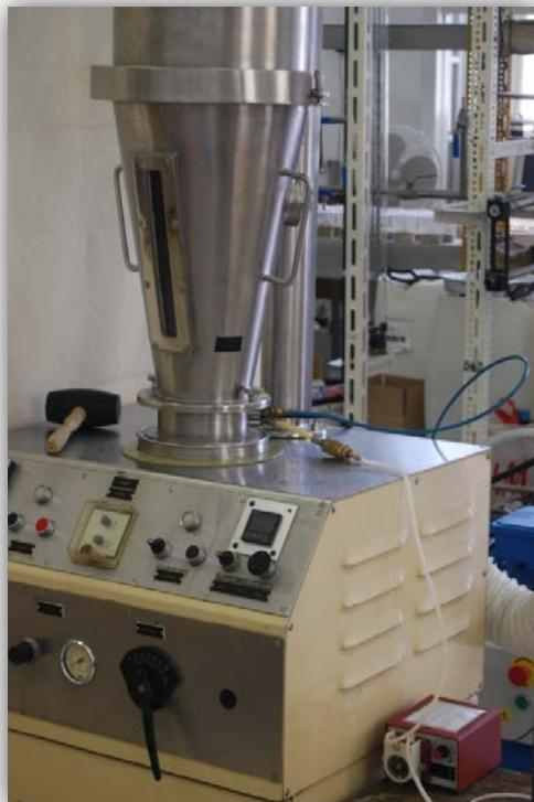
**Slika 3.1.** Fotografija granulatora s fluidiziranim slojem
