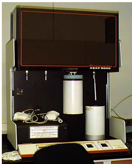
Slika 13. Uređaj za određivanje veličina pora, ASAP 2000 ( Micromeritics, SAD )
