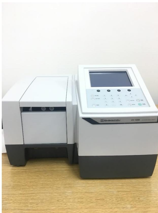
Slika 16. UV/VisS spektrofotometar UV-1280
