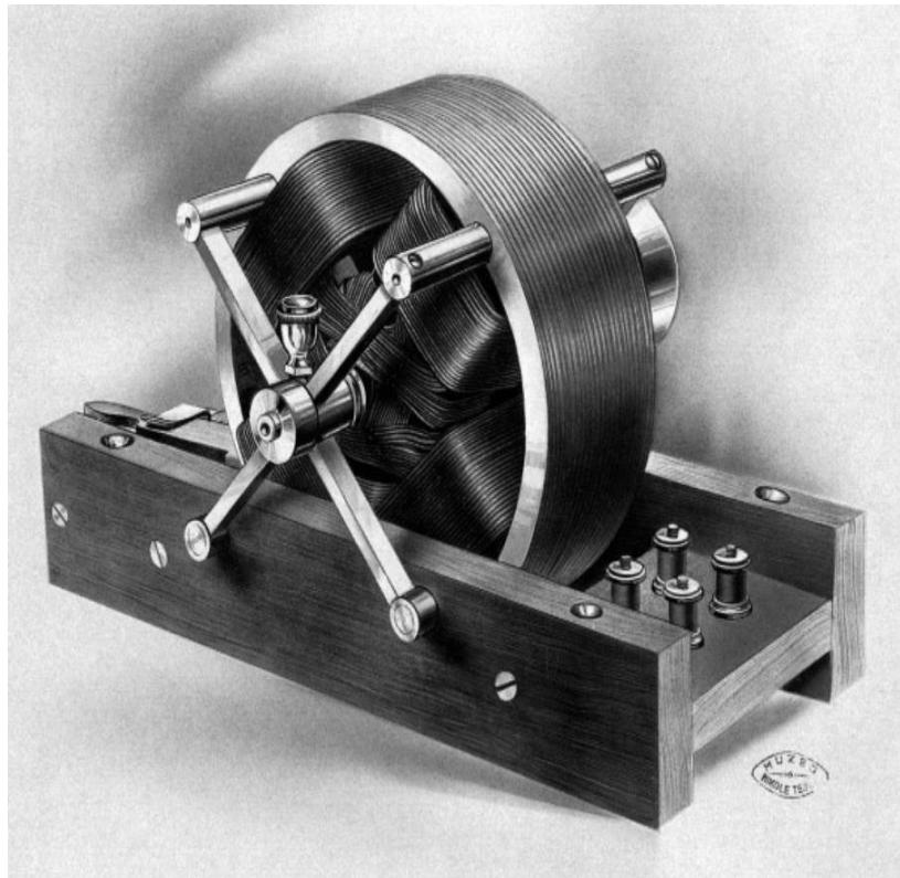
**Slika 6.** Prikaz Teslinog indukcijskog motora [13].
