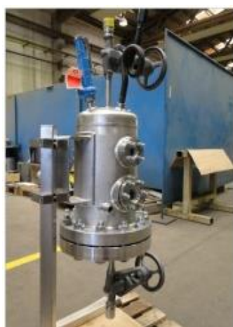
Prototip visokotlačnog separatora - »Ecom« Ruše, Slovenija.
