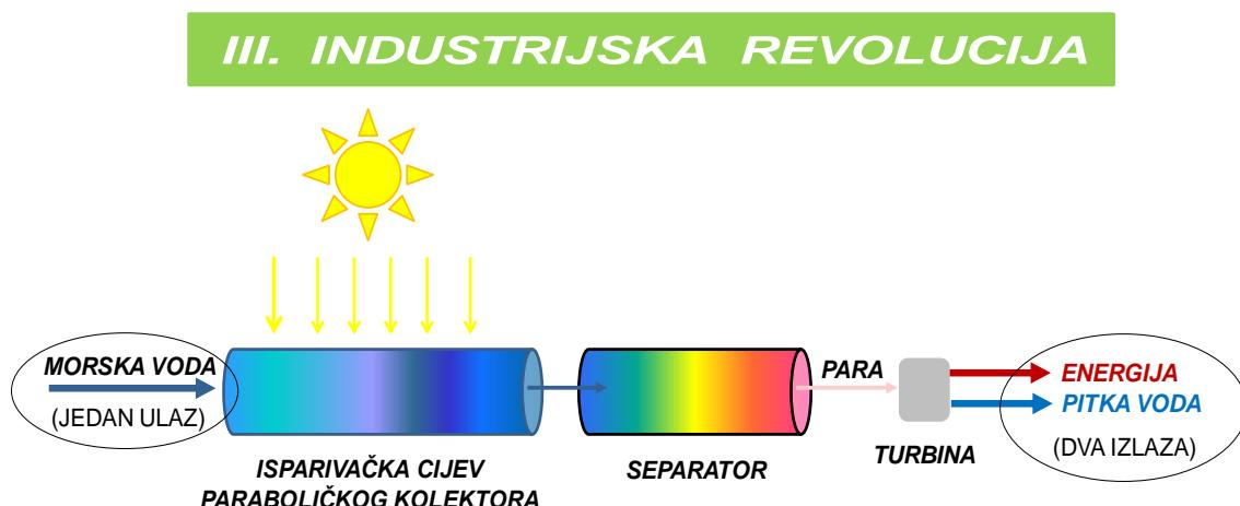
**Slika 10.** Koncept radikalno nove tehnologije – „Seawater Steam Engine“.
