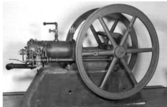
Slika 5. Prvi benzinski Otto motor [11].
