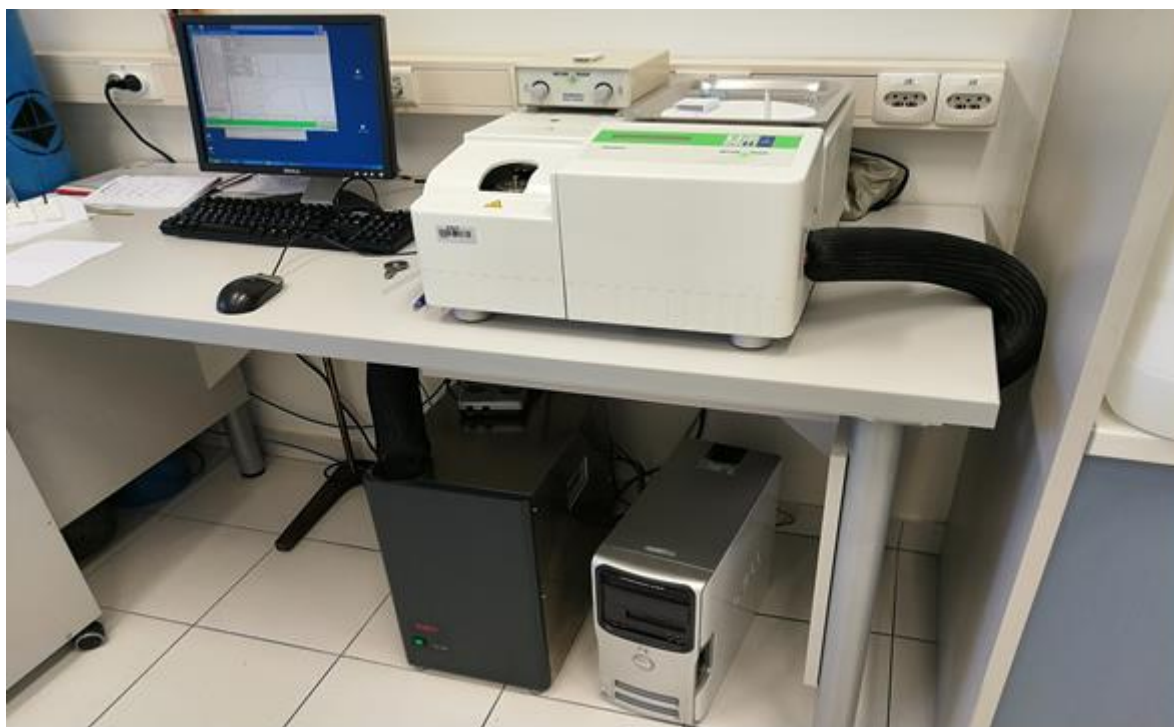
Slika 3.11. Diferencijalni pretražni kalorimetar Mettler Toledo s računalom.
