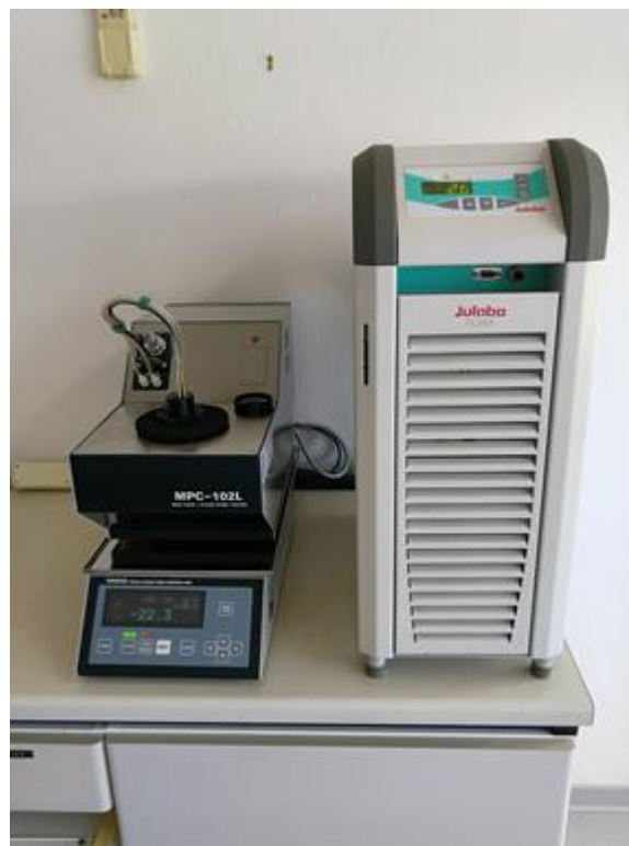
Slika 3.9. Prikaz instrumenta za određivanje tecišta Tanaka MPC-1021 uz kriostat Julabo F25.
