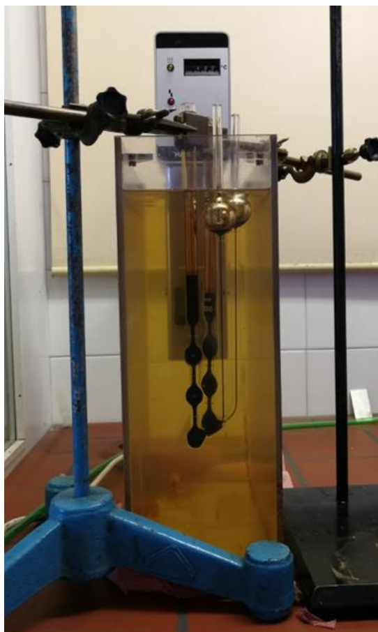
Slika 3.6. Prikaz termostatisirane uljne kupelji pri 40 °C i uronjenih viskozimetara za mjerenje viskoznosti.
