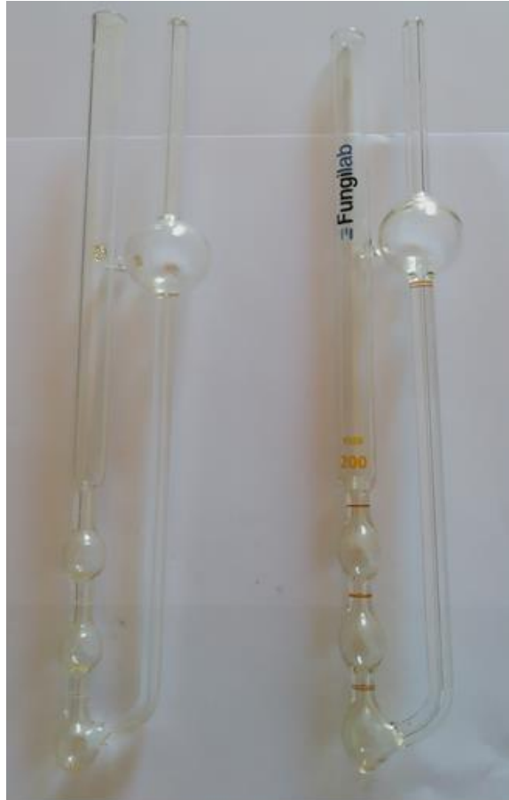
Slika 3.5. Viskozimetri korišteni za mjerenje viskoznosti; lijevi za uzorke uzorkovane s vrha, dok je desni korišten za uzorke uzorkovane s dna.
