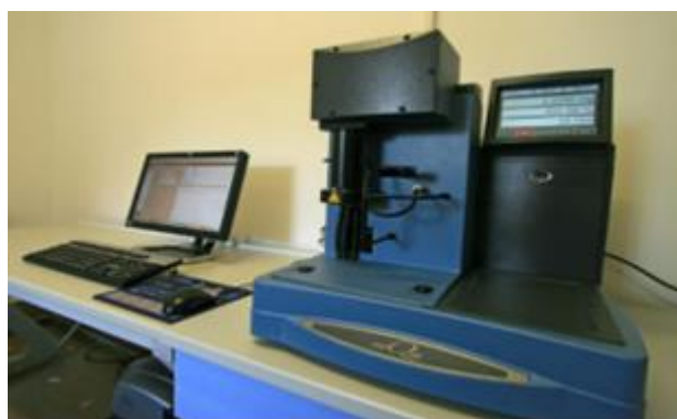
Slika 3.10. Uređaj korišten za provođenje termogravimetrijske analize.
