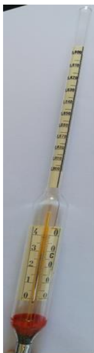
Slika 3.2. a) Areometar korišten u mjerenjima; b) Prikaz očitavanja vrijednosti gustoće na areometru za prozirne kapljevine.
