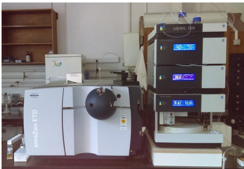
Slika 27. AmaZon ETD spektrometra masa s ionskom stupicom (Bruker Daltonik GmbH, Bremen, Njemačka) povezanim s Ultimate 3000 RSLCnano tekućinskim kromatografom ultravisoke djelotvornosti (Dionex, Amsterdam, Nizozemska)
