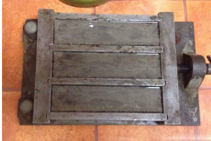
Slika 16. Kalup ispunjen cementnom pastom
