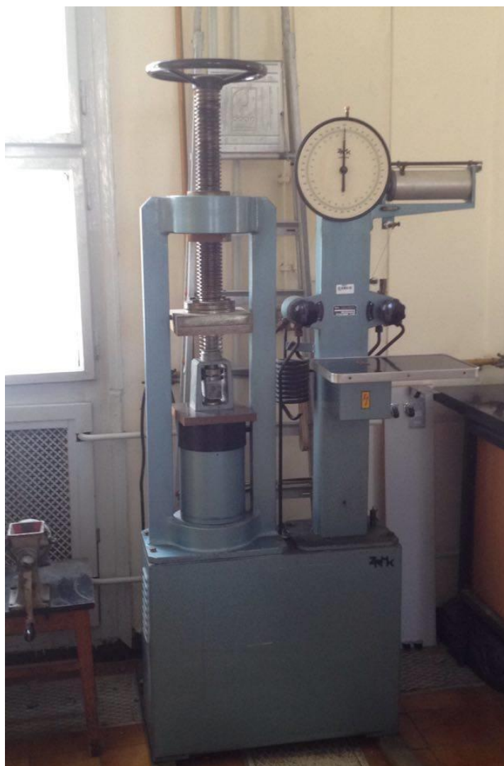
Slika 18. Hidraulična preša za određivanje čvrstoće na tlak
