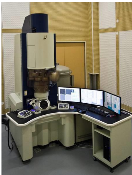
Slika 7. Transmisijski elektronski mikroskop atomske rezolucije, model ARM 200 CF, JEOL.
