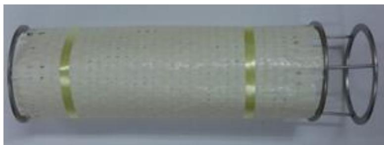
**Slika 3.4.** Katalizator na nosaču
