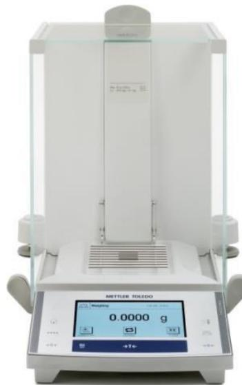
**Slika 10.** Analitička vaga XS204 Delta Range, Mettler Toledo
