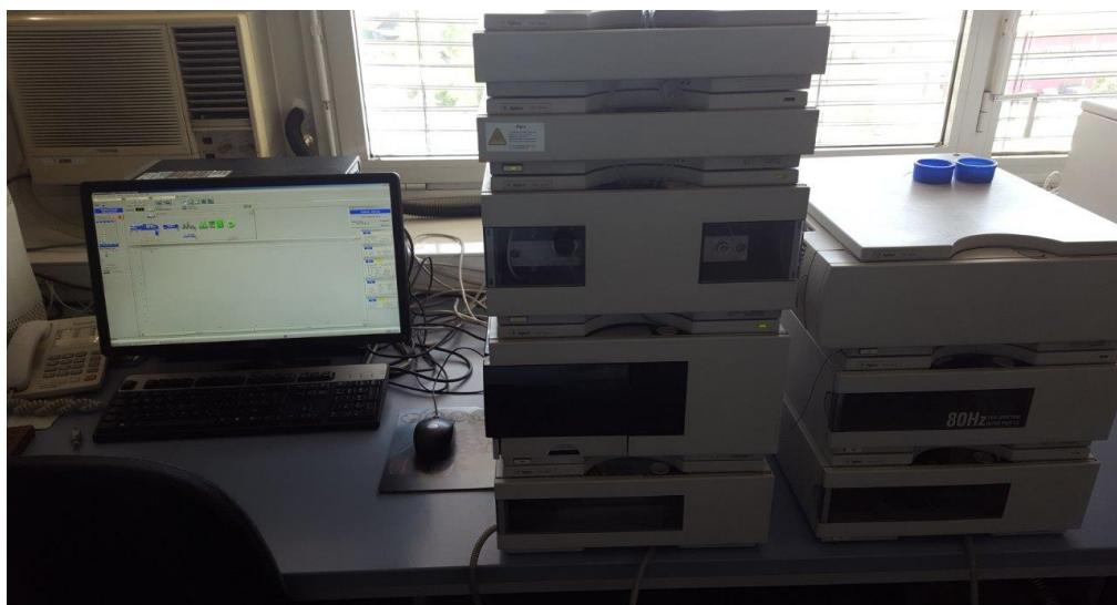
**Slika 14.** HPLC Agilent 1100 s DAD detektorom
