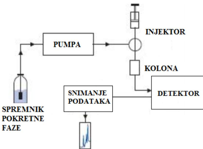
**Slika 8.** Shematski prikaz osnovnih dijelova HPLC uređaja [35]
