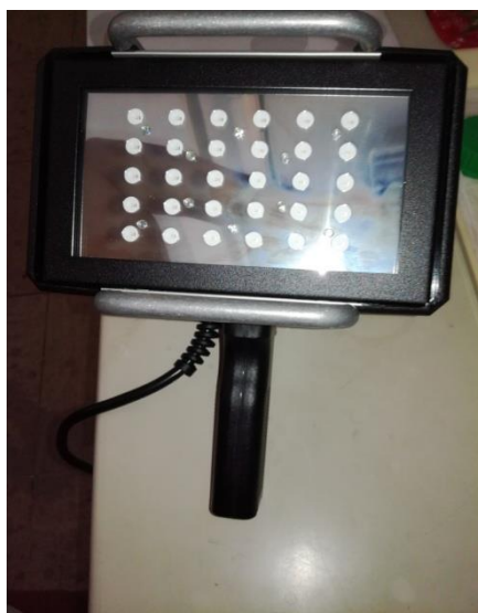
Slika 13. LED-svjetiljka koja emitira UV zračenje valne duljine 365nm
