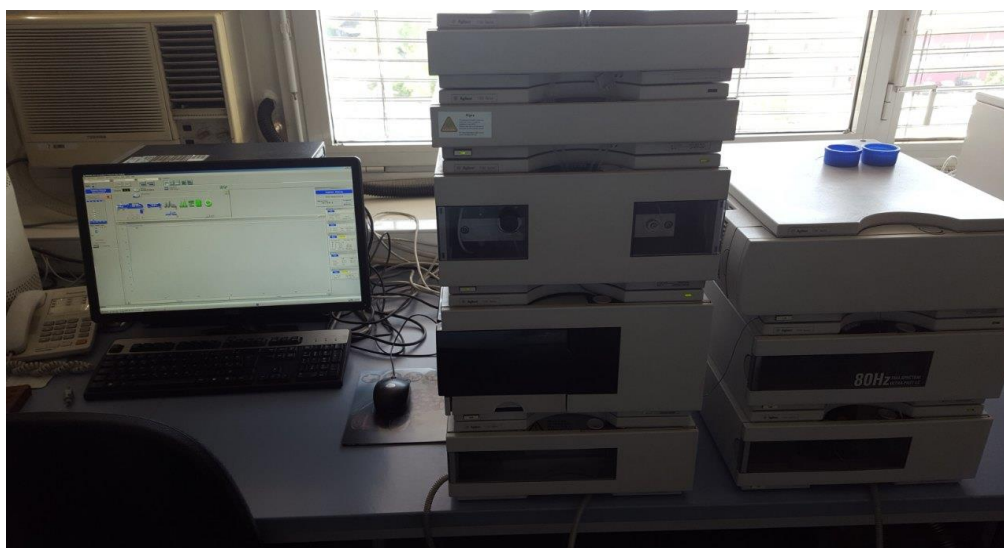
Slika 14. HPLC Agilent 1100 s DAD detektorom
