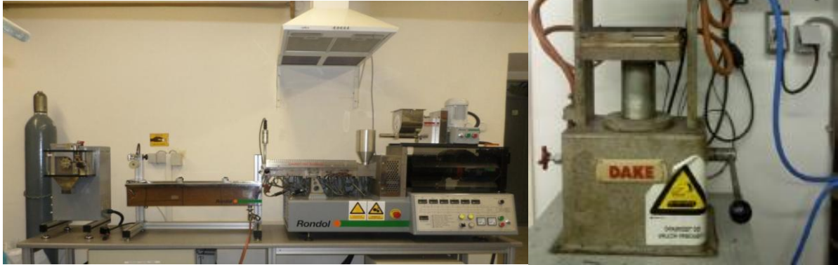
Slika 9 Rondol ekstruder (lijevo); Hidraulička preša Dake Model 44-226 (desno)
