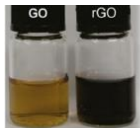
Slika 2.4. Promjena boja reakcijske smjese iz smeđe u crnu prilikom redukcije GO u rGO
