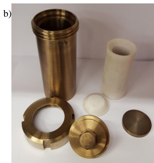
Slika 3.1. Prikaz a) Anton Paar Monowave 300 reaktor za hidrotermalnu sintezu potpomognutu mikrovalovima i b) autoklav – hidrotermalni reaktor
