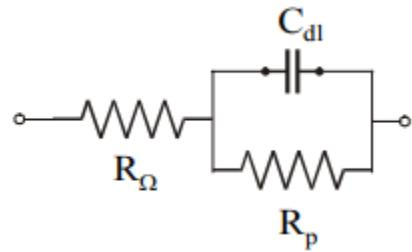
Slika 2.28. Prikaz električnog ekvivalentnog kruga jednostavne elektrokemijske ćelije
