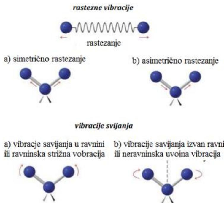
Slika 2.33. vrste vibracija kovalentnih veza ispitivanih molekula u IR spektroskopiji
