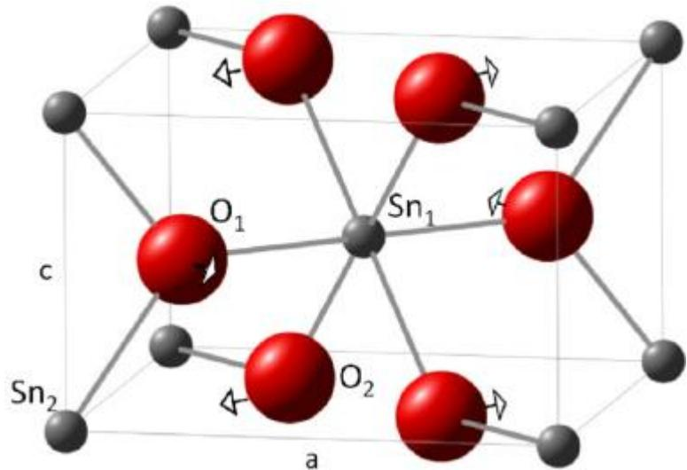
Slika 2.13. Shematski prikaz rutilne strukture  $\text{SnO}_2$
