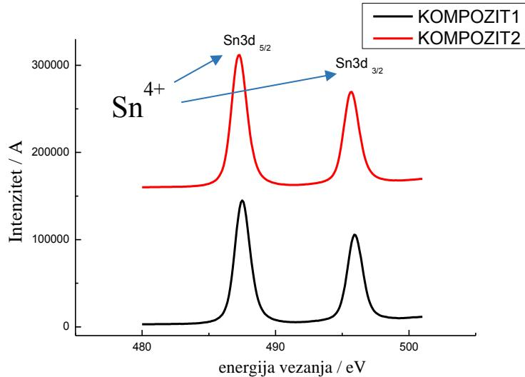
Slika 4.13. XPS spektar za *KOMPOZIT 1* i *KOMPOZIT 2* u uskom području energija vezanja
