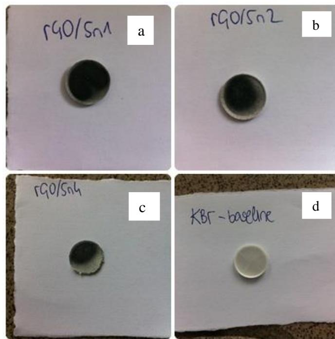
Slika 3.13. Uzorci kompozitnih materijala rGO/SnO<sub>2</sub> s KBr komprimirani u obliku pastile a) *KOMPOZIT 1*, b) *KOMPOZIT 2*, c) *KOMPOZIT 3* i d) KBr
