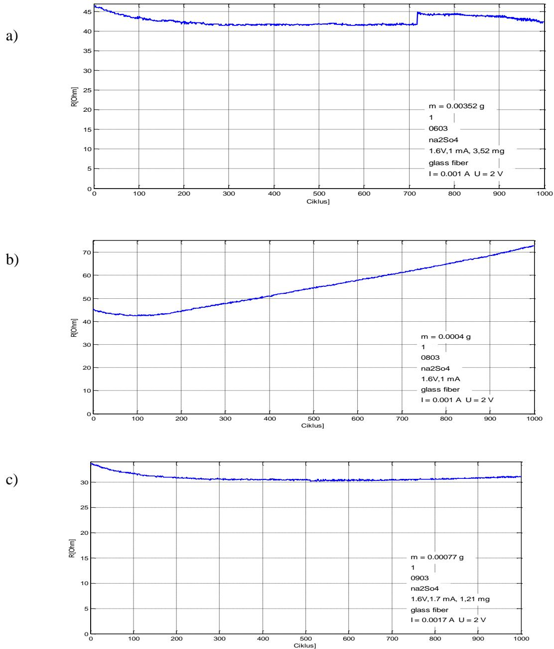
Slika 4.6. Promjena unutarnjeg otpora superkondenzatora s brojem ciklusa punjenja i pražnjenja za a) *Superkondenzator1*, b) *Superkondenzator2* i c) *Superkondenzator3*
