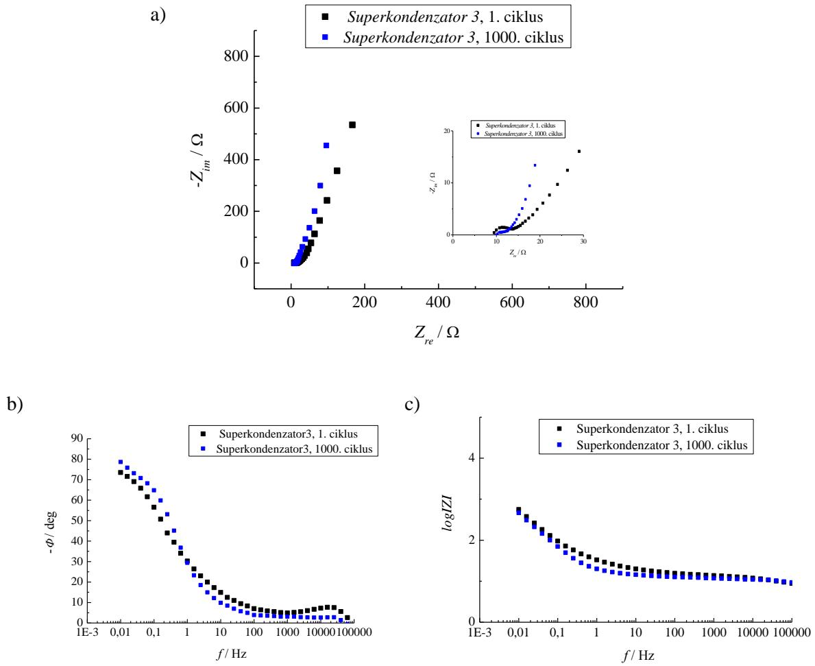
Slika 4.9. Prikaz EIS rezultata mjerjenja za *Superkondenzator3* pri potencijalu 0V; a) Nyquistov dijagram, b) i c) Bodeov dijagram
