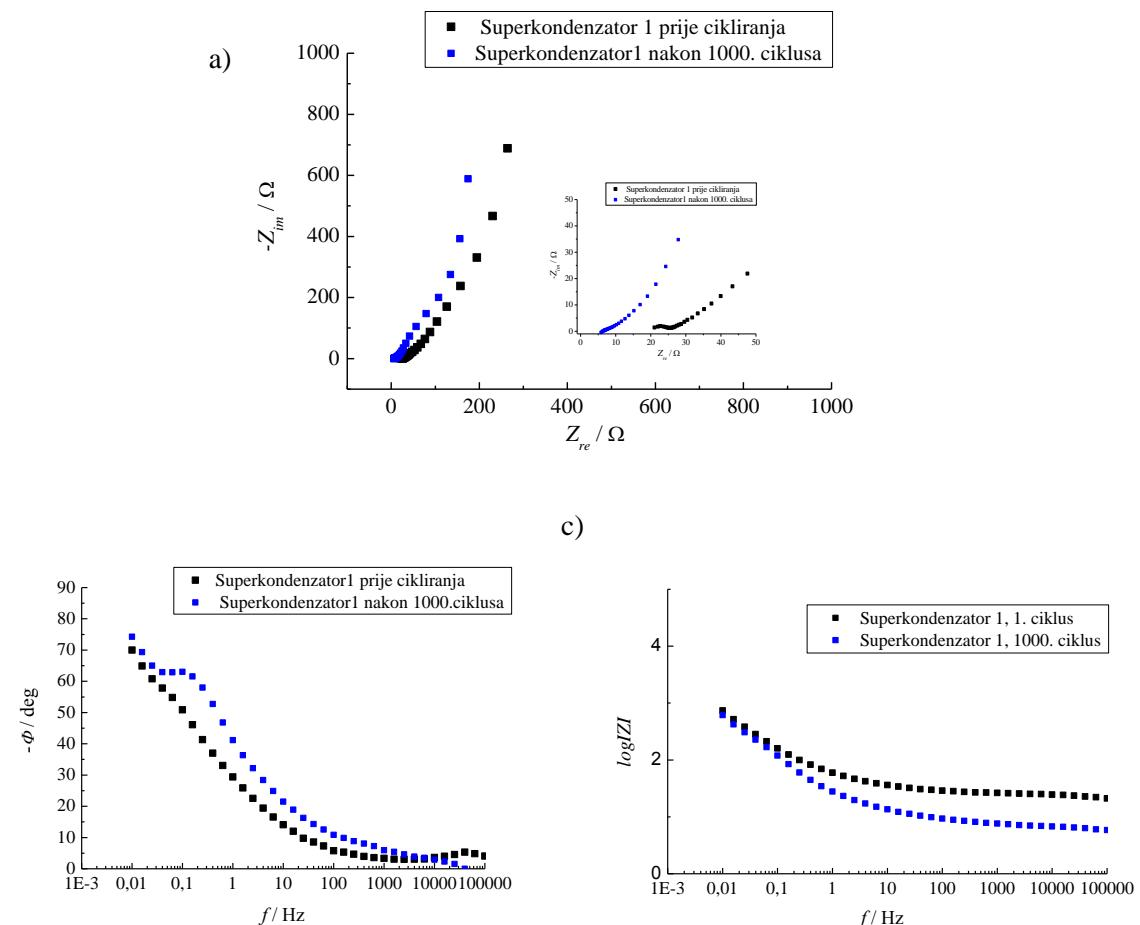
Slika 4.7. Prikaz EIS rezultata mjerena za *Superkondenzator1* pri potencijalu 0 V; a) Nyquistov dijagram, b) i c) Bodeov dijagram
