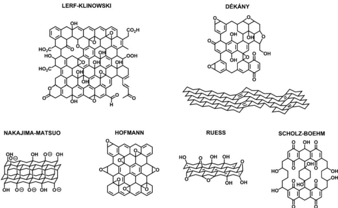
Slika 2.2. Prepostavljene strukture grafitovog oksida
