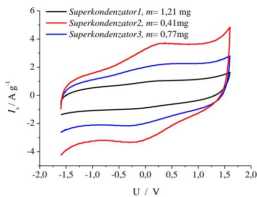
Slika 5.3. Ciklički voltamogrami pripravljenih superkondenzatora u rasponu napona -1,6 – 1,6V pri brzini promjene potencijala od 50 mV s<sup>-1</sup>
