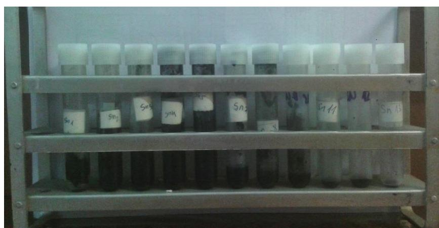
Slika 3.2. Suspenzija kompozita rGO/ $\text{SnO}_2$
