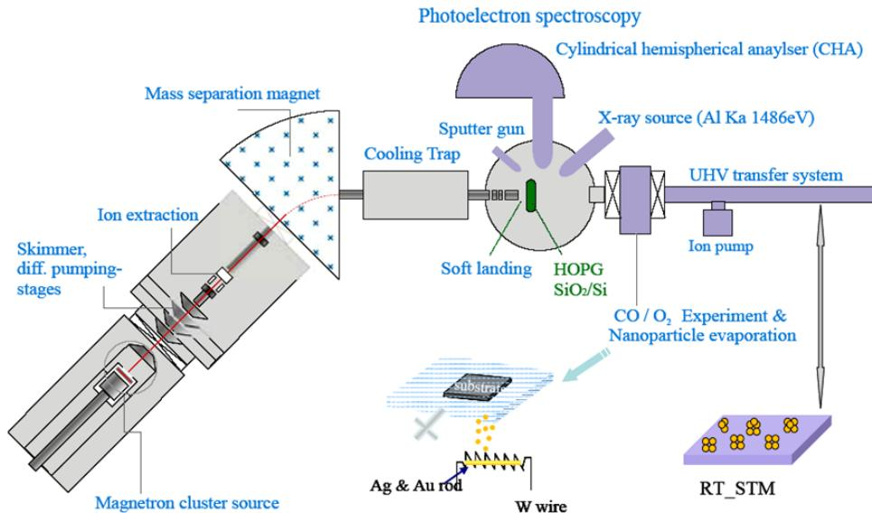
Slika2.31. Shematski prikaz XPS sprektrofotometra
