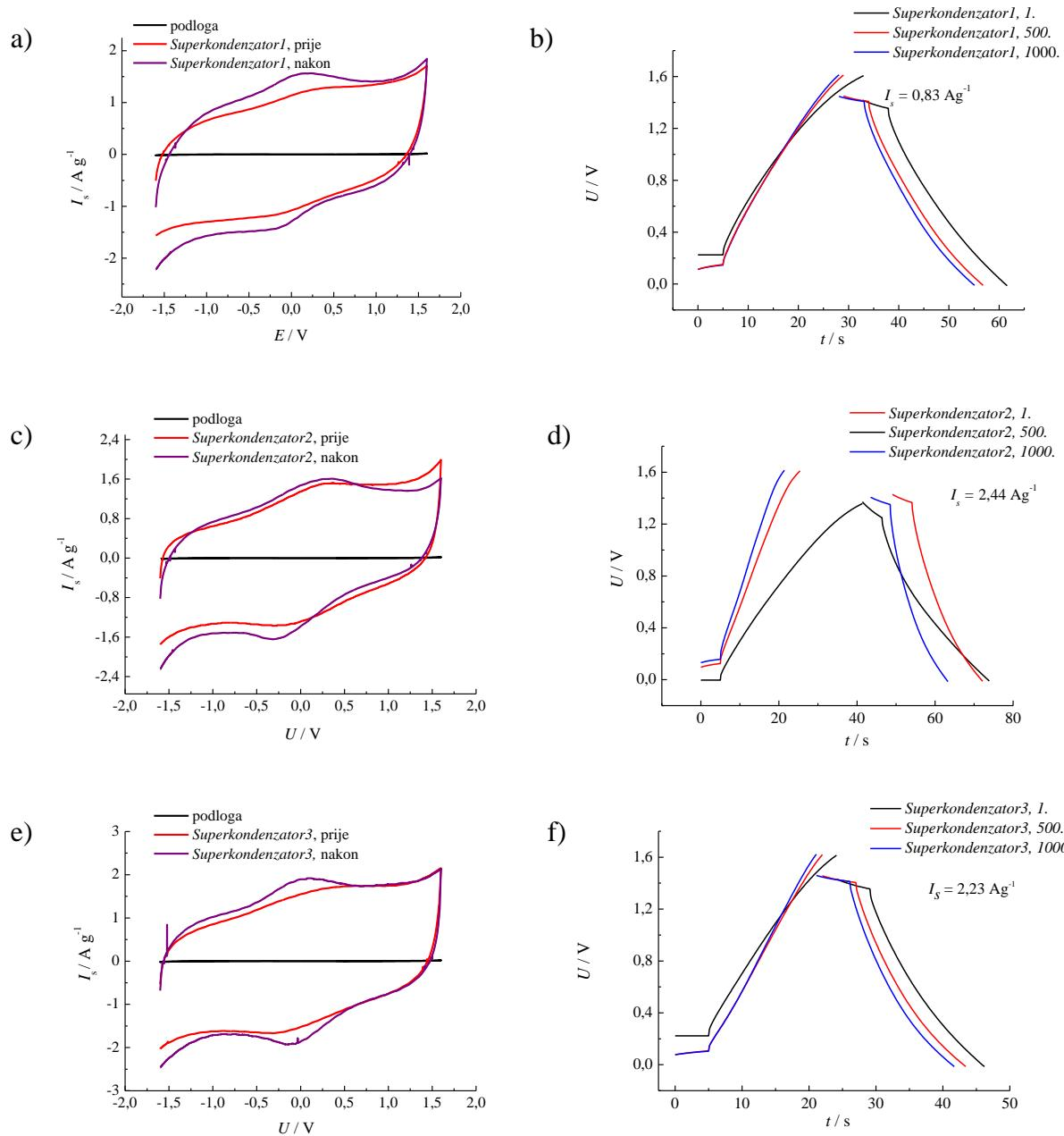
Slika 4.2. Prikaz cikličkih voltamograma prije i nakon provođenja punjenja/praznjenja kod konstantne struje pri brzini promjene potencijala od  $50 \text{ mVs}^{-1}$  za a) *Superkondenzator 1*, c) *Superkondenzator 2* i e) *Superkondenzator 3*. Prikaz krivulja za 1., 500. i 1000. ciklus punjenja i praznjenja za b) *Superkondenzator 1*, d) *Superkondenzator 2* i f) *Superkondenzator 3*
