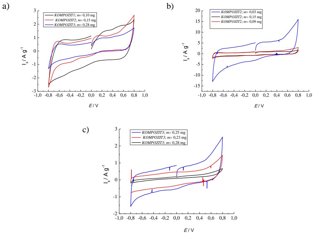
Slika 4.1. Ciklički voltamogrami elektroda s određenom masom uzorka za a) *KOMPOZIT 1*, b) *KOMPOZIT 2* i d) *KOMPOZIT 3* zabilježeni u  $0,5 \text{ mol dm}^{-3} \text{ Na}_2\text{SO}_4$  uz brzinu promijene potencijala od  $v=50 \text{ mVs}^{-1}$
