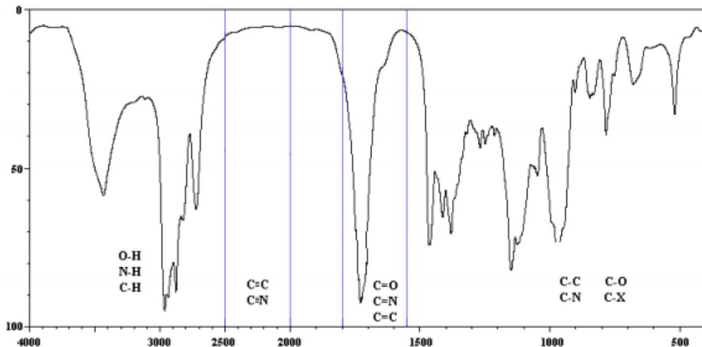
Slika 2.32. Prikaz FTIR spektra u kojem su uočljive karakteristične vibracije za veći dio veza
