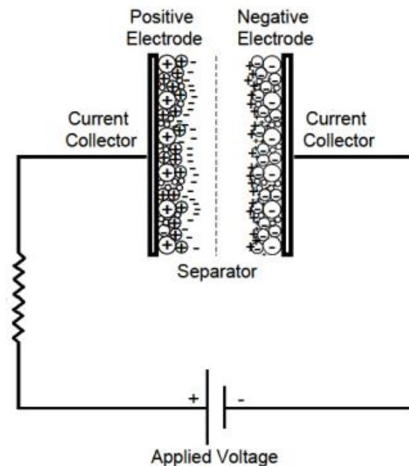
Slika 2.18. Shema superkondenzatora
