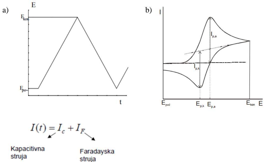
Slika 2.21. Prikaz a) signalata pobude i b) signalata odziva u cikličkoj voltametriji
