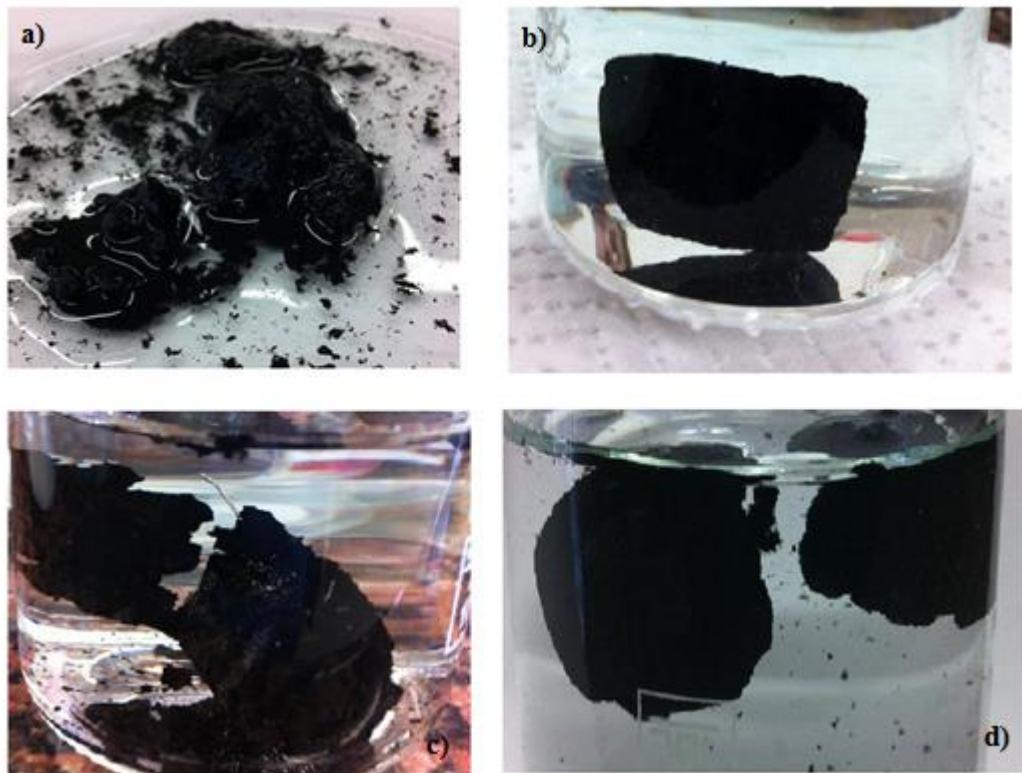
Slika 3.5. Prikaz dobivenih hidrogelova : a) KOMPOZIT 21, b) KOMPOZIT 22, c) KOMPOZIT 22 s Pt-mrežicom i d) KOMPOZIT 23.
