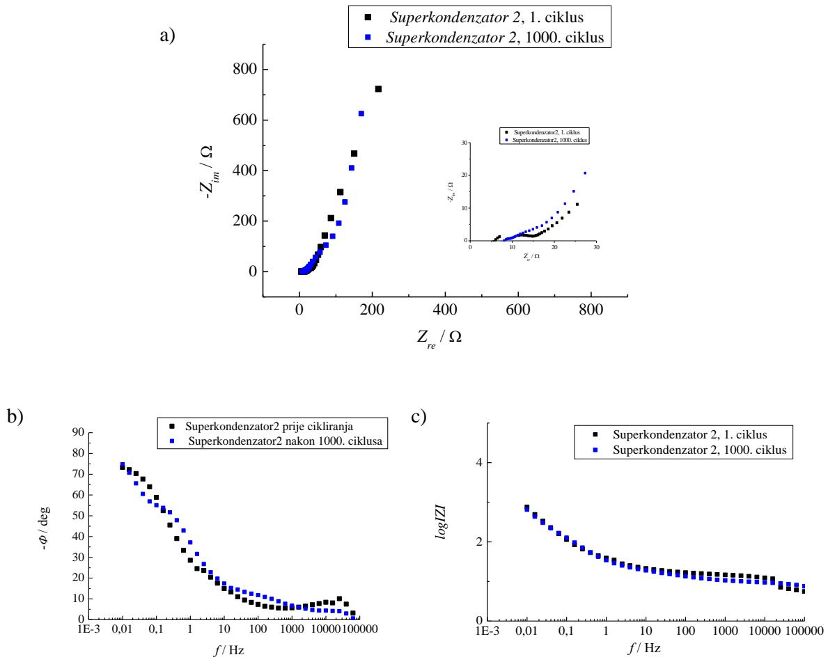
Slika 4.8. Prikaz EIS rezultata mjerena za *Superkondenzator 2* pri potencijalu 0 V; a) Nyquistov dijagram, b) i c) Bodeov dijagram
