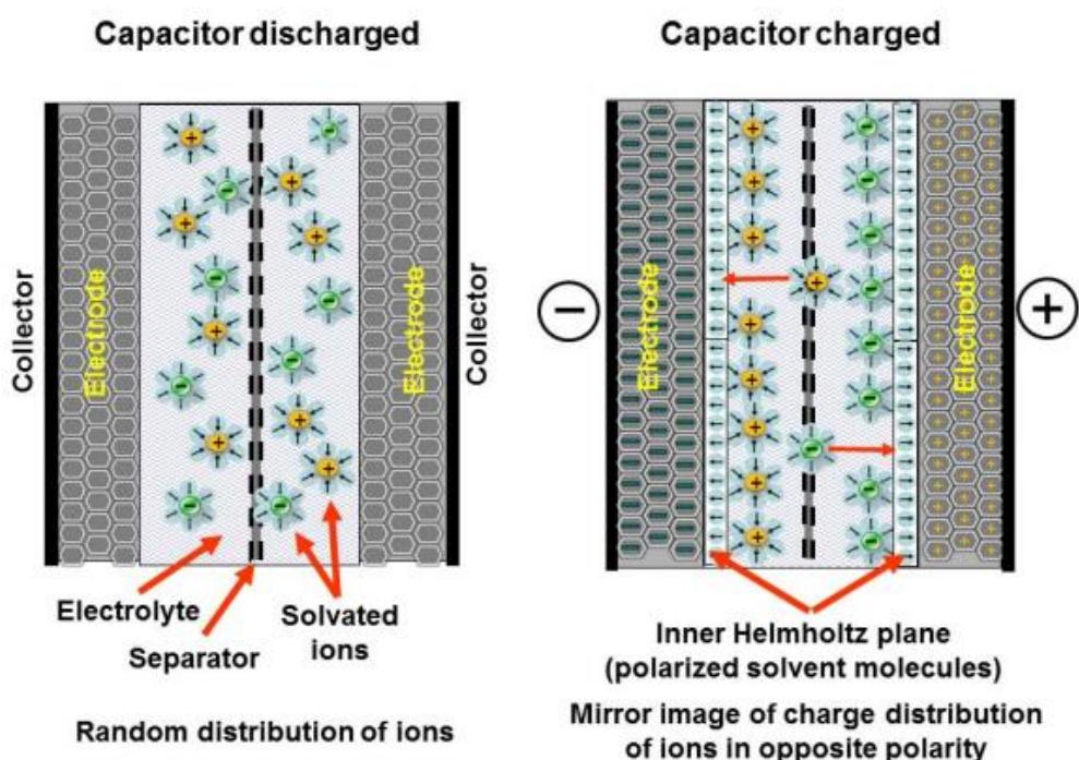
Slika 2.19. Prikaz ispraznjenog (lijevo) i napunjenog (desno) kondenzatora
