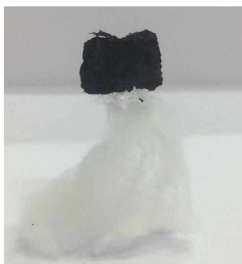
Slika 3.11. Dobiveni aerogel uzorka *KOMPOZIT 22* nakon provedene liofilizacije
