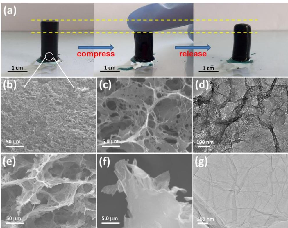
Slika 2.12. Prikaz grafenskog hidrogela i rupičastih grafenskih listova dobivenih solvatotermalnim postupkom iz GO ( $\gamma=2,0 \text{ mg ml}^{-1}$ ) u sferi Ar i zraka; a) digitalna fotografija HGA i prikaz njegovih elastičnih svojstva nakon izvršene kompresije. SEM (b, c, e, f) i TEM (d, g) snimaka HGA (b-d) i grafenski hidrofelovi (e-g). [14]
