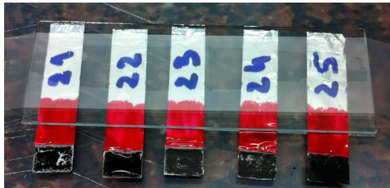
Slika 3.4. Radna elektroda
