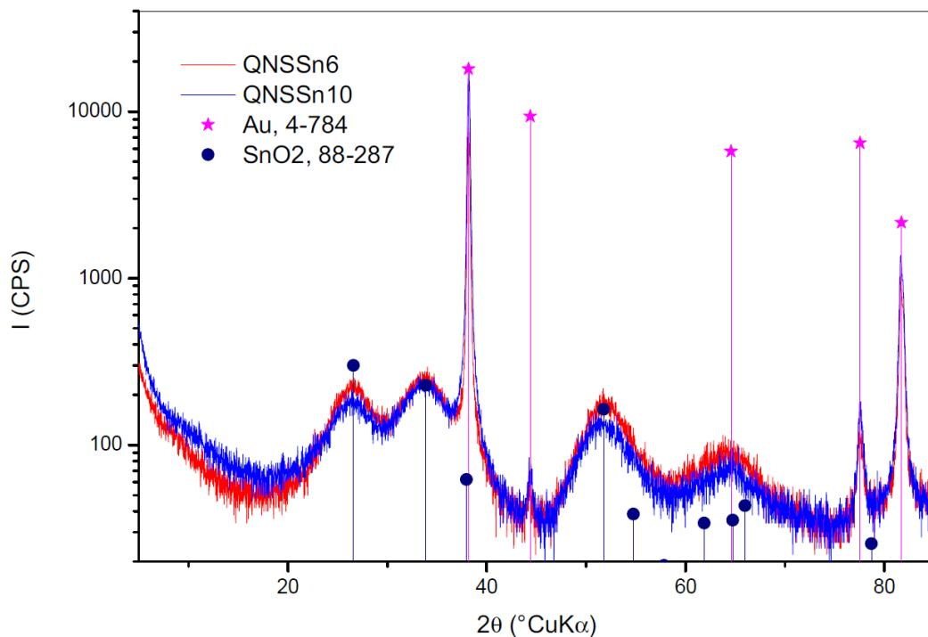
Slika 4.17. Difrakcijska slika/rentgenogram s logaritamskom skalom za *KOMPOZIT 1* i *KOMPOZIT 2*
