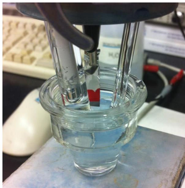
Slika 3.8. Troelektrodni sustav na kojem su provedena mjerena metodom cikličke voltametrije
