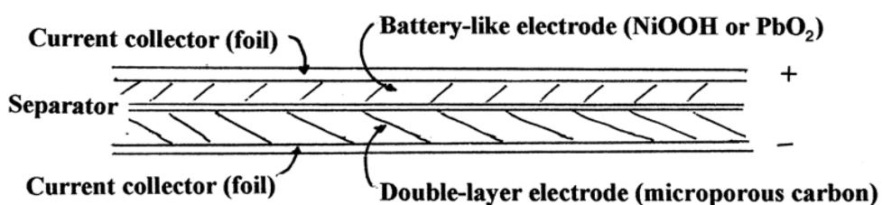
Slika 2.20. Shematski prikaz hibridnog električnog superkondenzatora
