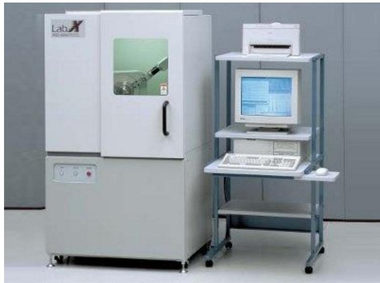
Slika 3.14. XRD Shimadzu 6000
