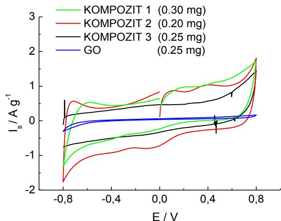
Slika 5.1. Ciklički voltamogram GO i kompozitnih materijala dobivenih hidrotermalnom redukcijom potpomognutom mikrovalovima
