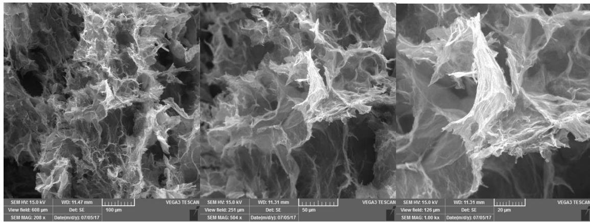
Slika . SEM analize dobivenog hidrogela – *KOMPOZIT* 22
