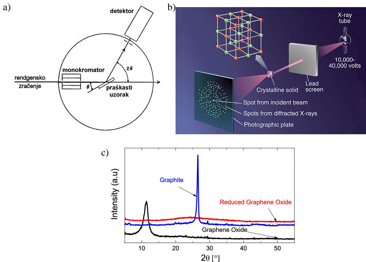
Slika 3.35. a) Shematski prikaz goniometra s označenim difrakcijskim kutom,  $\theta$  i kutom zakretanja goniometra ( $2\theta$ ) i b) osnovni prikaz difraktometra i c) difraktogram grafita (G), grafenovog oksida (GO) i grafena (rGO)
