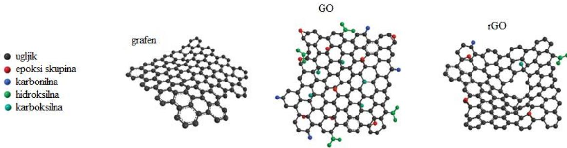
Slika 2.8. Prikaz strukture idealnog grafena, grafenova oksida (GO) i reduciranih GO (rGO)
