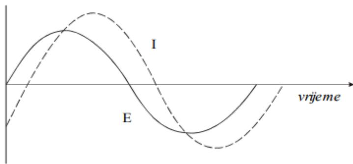
Slika 2.24. Prikaz sinusoidnih valova potencijala i struje
