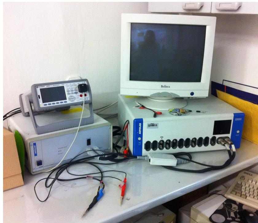
Slika 3.9. Potenciostat/galvanostat AUTOLAB
