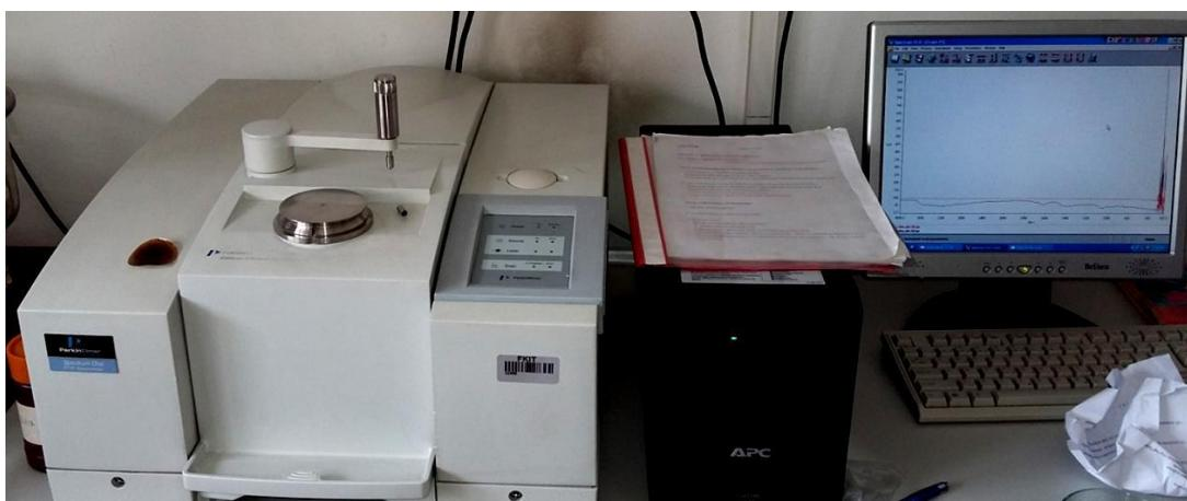
Slika 3.12. FT-IR spektrofotometar
