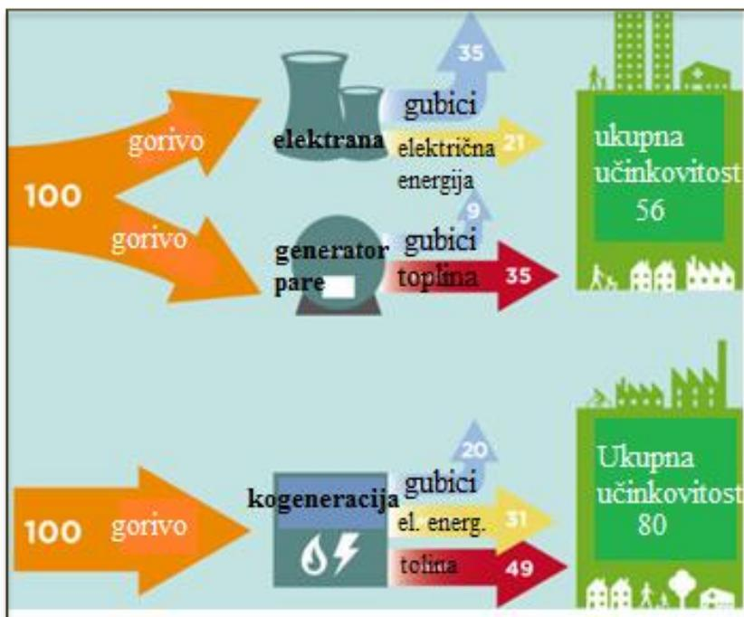
**Slika 2.** Usporedba gubitaka u odvojenoj i kogeneracijskoj proizvodnji električne i toplinske energije<sup>9</sup>
