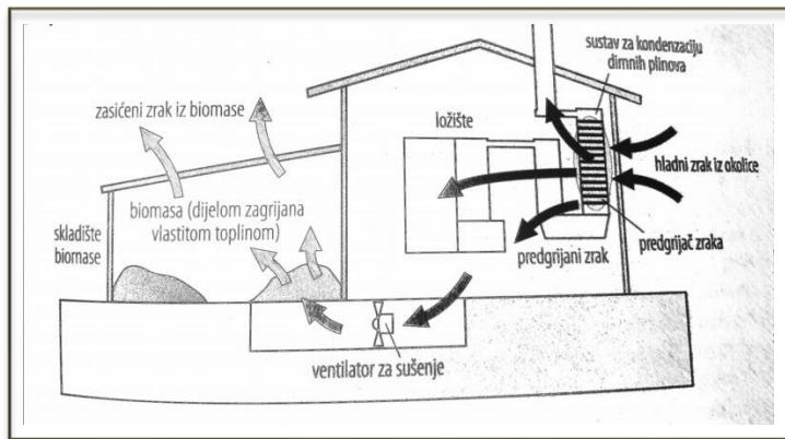
**Slika 10.** Sušenje biomase u skladištu pomoću zraka pregrijanog dimnim plinovima<sup>19</sup>
