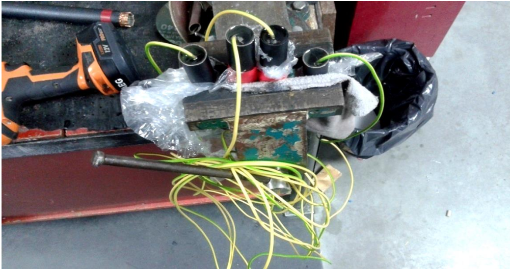
Slika 25. MMO anode s kontaktom učvršćene epoksidom
