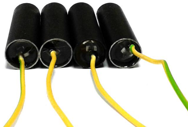
Slika 26. Završni oblik pripremljenih MMO anoda
