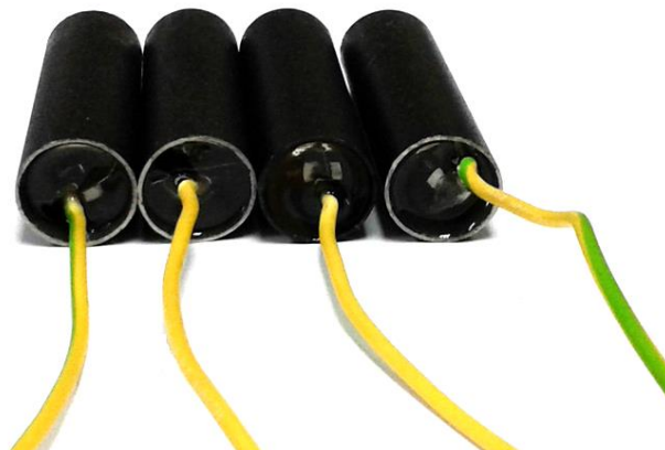
Slika 26. Završni oblik pripremljenih MMO anoda
