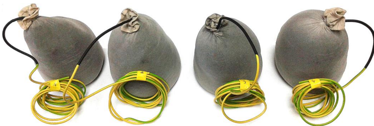
Slika 27. Četiri uzorka MMO anoda istih dimenzija s različitim koksnim punilom
