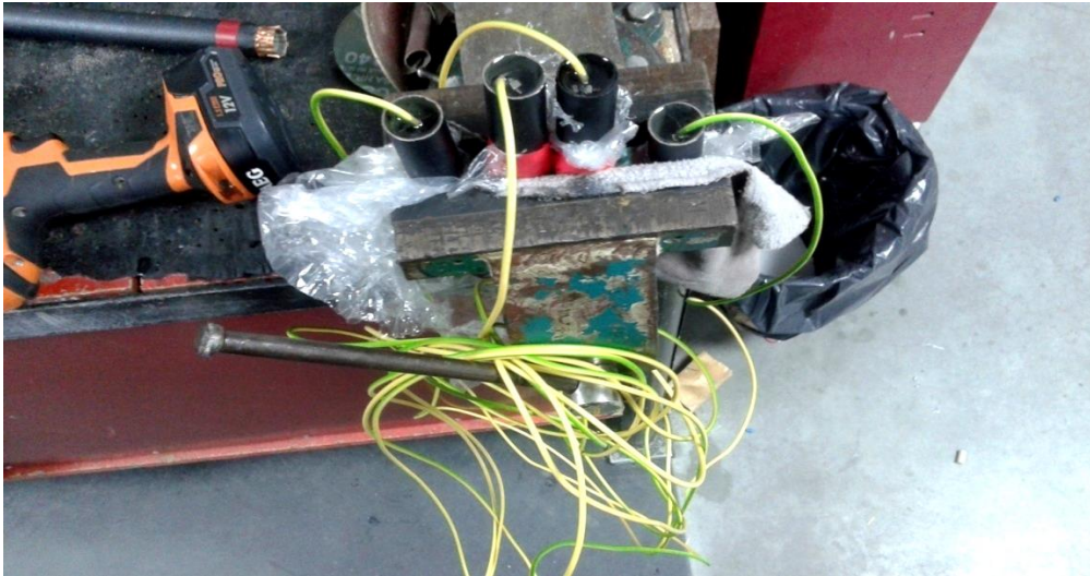
Slika 25. MMO anode s kontaktom učvršćene epoksidom
