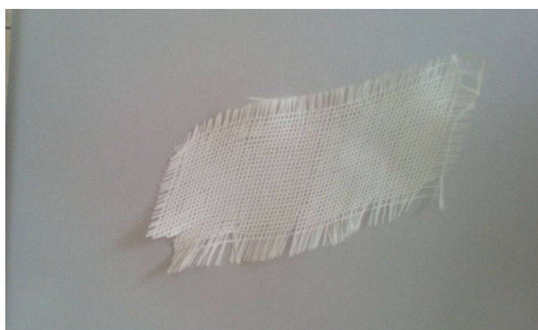
Slika 9. Prevlake dobivene kristalizacijom iz otopine na staklenoj mrežici
