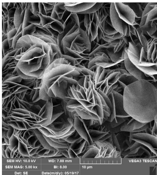
Slika 18. SEM snimke uzorka FK5 sušenog na 100 °C, povećanje 5000 x
