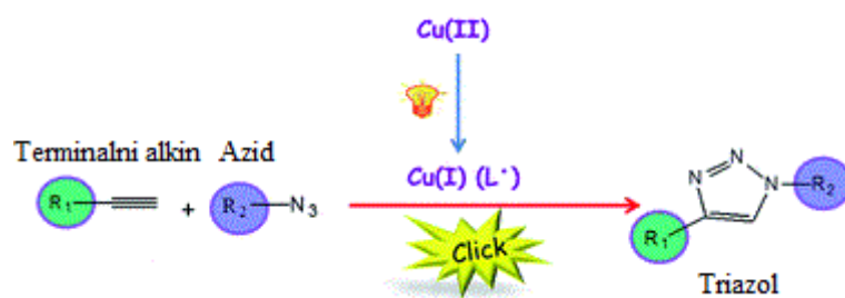
Slika 2. Pojednostavljena reakcijska shema bakrom kataliziranih klik reakcija [6]
