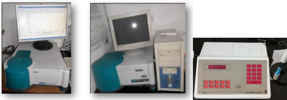
Slika 13. a) UV-vidljivi apsorpcijski spektrofotometar; b) fluorescencijski spektrofotometar, c) pH metar Iskra MA 5740
