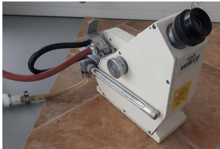
Slika 3.3. Abbeov refraktometar RL3, PZO Varšava
