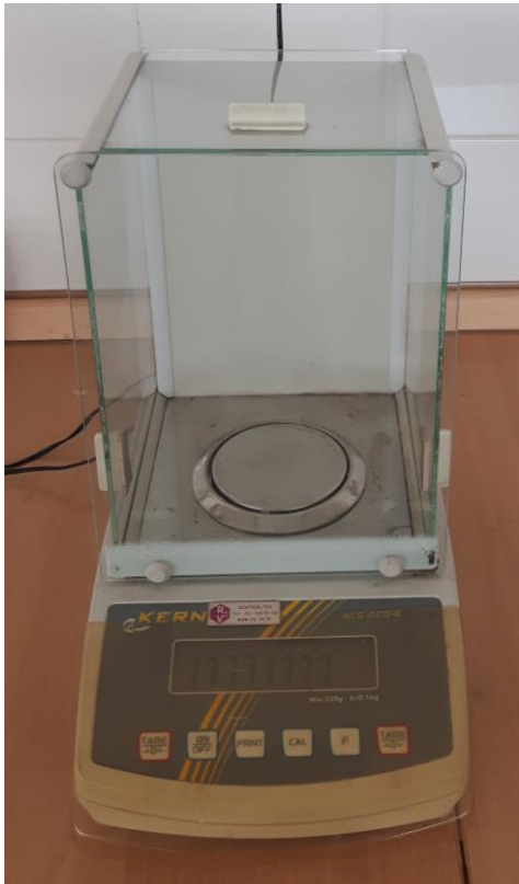
Slika 3.1. Analitička vaga KERN, ALS 220-4
