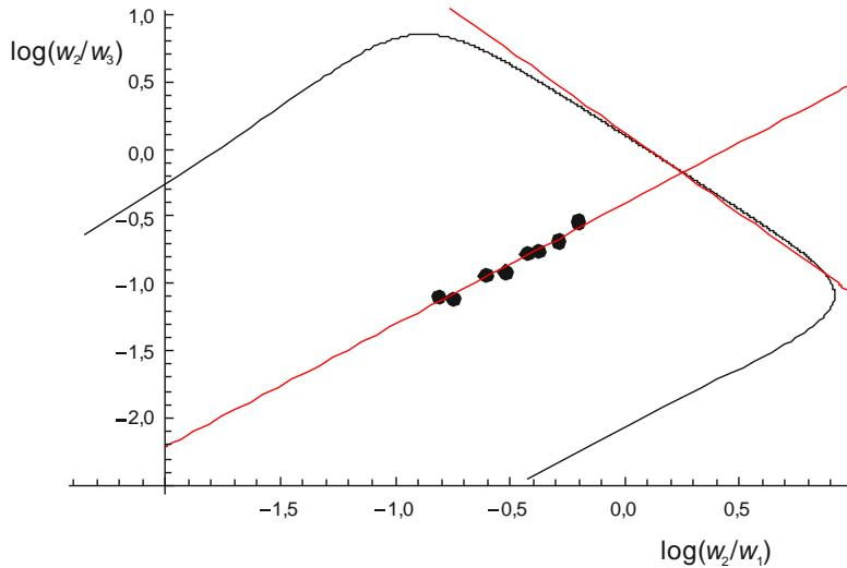
**Slika 4.11.** Treybalov dijagram za sustav dimetil-adipat (1) – propionska kiselina (2) – voda (3). Točke se izračunavaju iz veznih linija, uzvodni crveni pravac je Handova aproksimacija, crna krivulja je transformirana binodalna krivulja, a silazni crveni pravac je aproksimacija njenog vršnog dijela. Na sjecištu dvaju crvenih pravaca nalazi se kritična točka.
