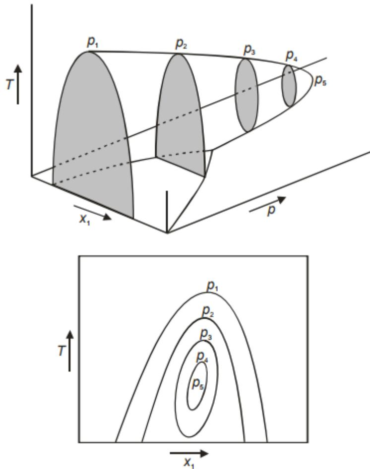
**Slika 2.8.** Shematski prikaz ovisnosti mješljivosti dvokomponentnog kapljevitog sustava o tlaku i temperaturi – fazni dijagram. Mješljivost dviju kapljevina općenito se povećava s porastom tlaka [8].
