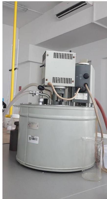
Slika 3.2. Termostatirana zračna kupelj MLW
