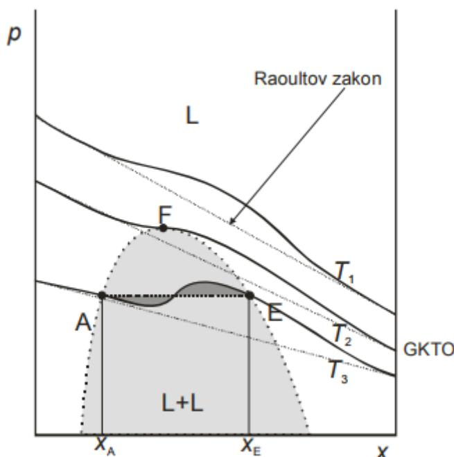
**Slika 2.74.** Ovisnost tlaka para djelomično mješljivog sustava dvokomponentnog kapljevitog sustava o temperaturi i interpretacija gornje kritične temperature otopine.
