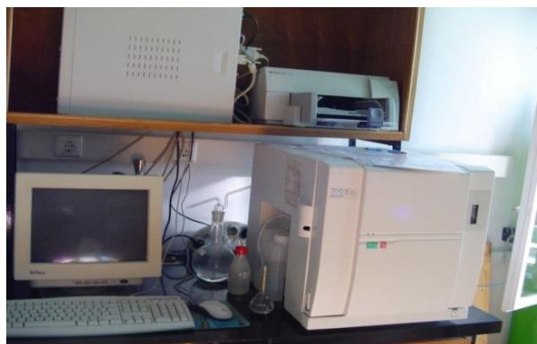
**Slika 11.** TOC analizator, TOC-VCPN, Shimadzu.
