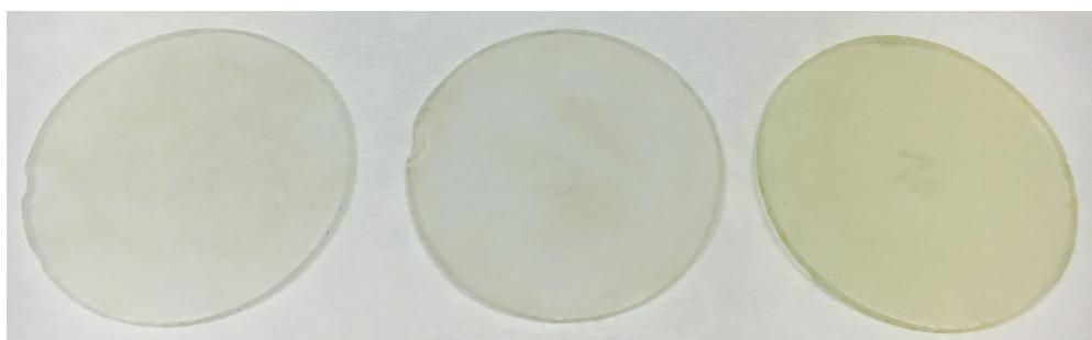
**Slika 22.** Pločice s immobiliziranim fotokatalizatorom nakon korištenja u 6. ciklusa fotokatalitičke obrade DCF-a, s lijeva na desno – kemijski reaktivirana pločica, topplinski reaktivirana te sušena pločica (bez reaktivacije).
