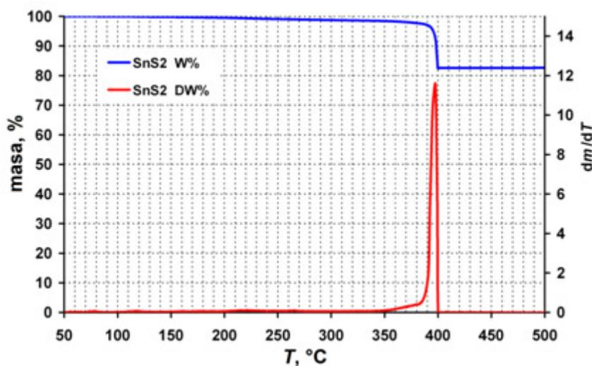
**Slika 16.** Termogravimetrijska analiza toplinske (oksidacijske) stabilnosti hidrotermalnog  $\text{SnS}_2$ .
