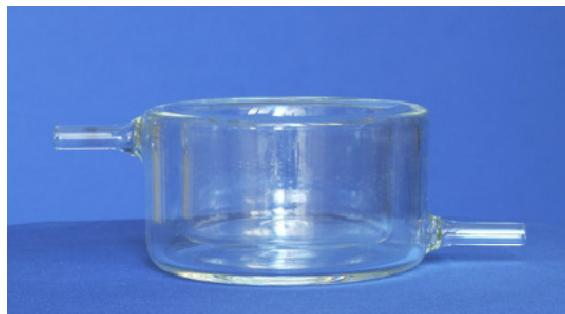
**Slika 8.** Kotlasti reaktor sa vodenim hlađenjem
