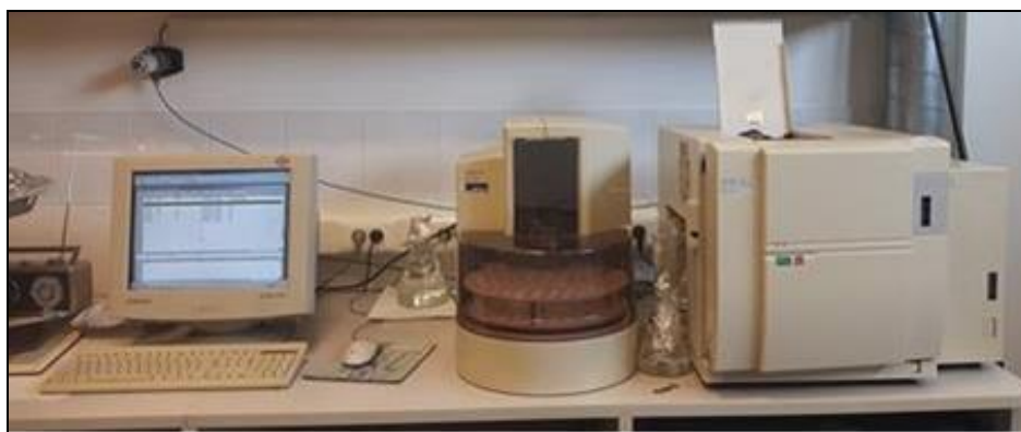
Slika 9. TOC analizator, Shimadzu TOC-V CPH + ASI-V autosampler.
