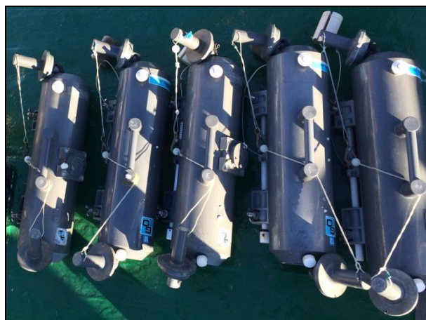
Slika 12. PET (polietilen tereftalat) boce za prikupljanje uzoraka morske vode.
