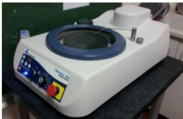
Slika 5. Uređaj za poliranje Buehler MetaServ 250, Grinder – Polisher
