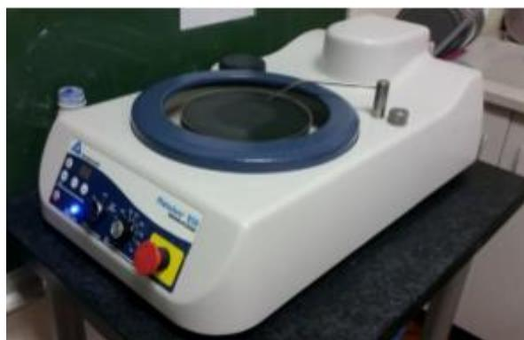
*Slika 5.* Uređaj za poliranje Buehler MetaServ 250, Grinder – Polisher
