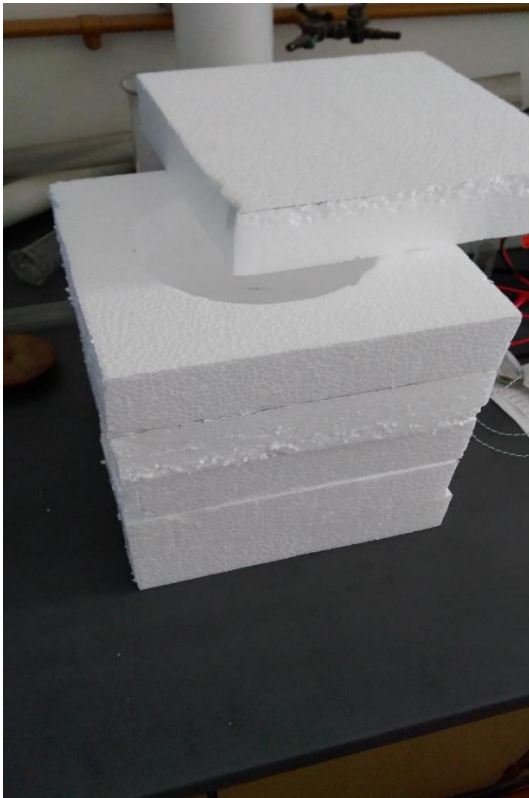
Slika 3.2.4 Izrada izolacijskog spremnika za aparaturu v
