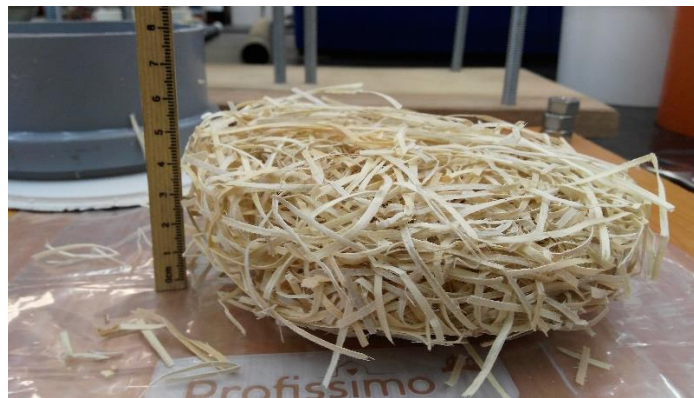
Slika 2.4.2 Drvena vuna, vlaknasto punilo u drvolitu v
