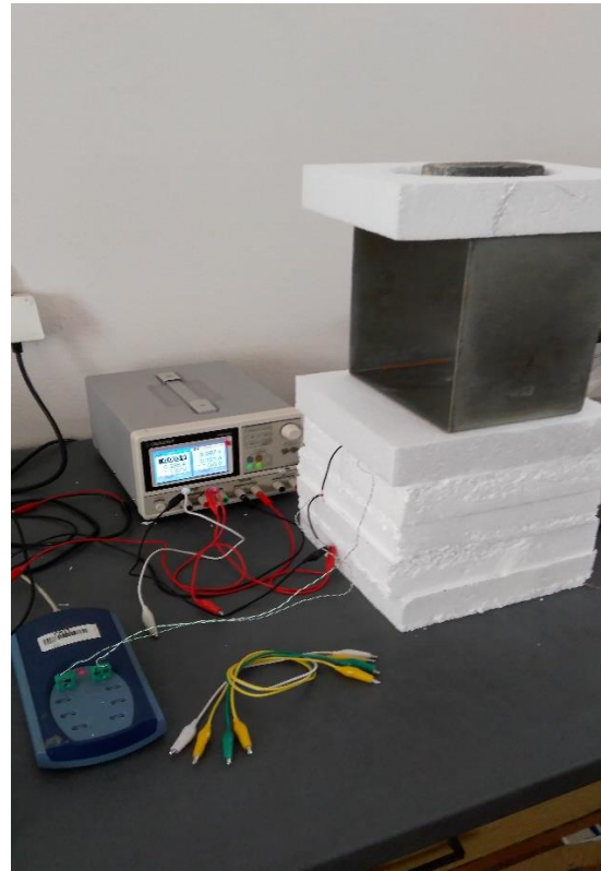
Slika 3.2.4 Izrada izolacijskog spremnika za aparaturu v
