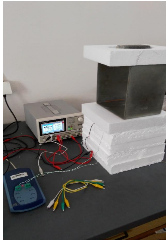
Slika 3.2.4 Izrada izolacijskog spremnika za aparaturu v
