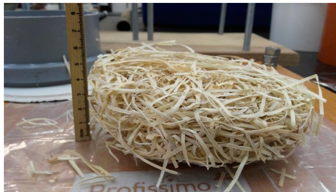
Slika 2.4.2 Drvena vuna, vlaknasto punilo u drvolitu v
