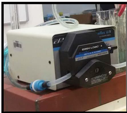
Slika 3.2. Pumpa s podesivom brzinom protoka
