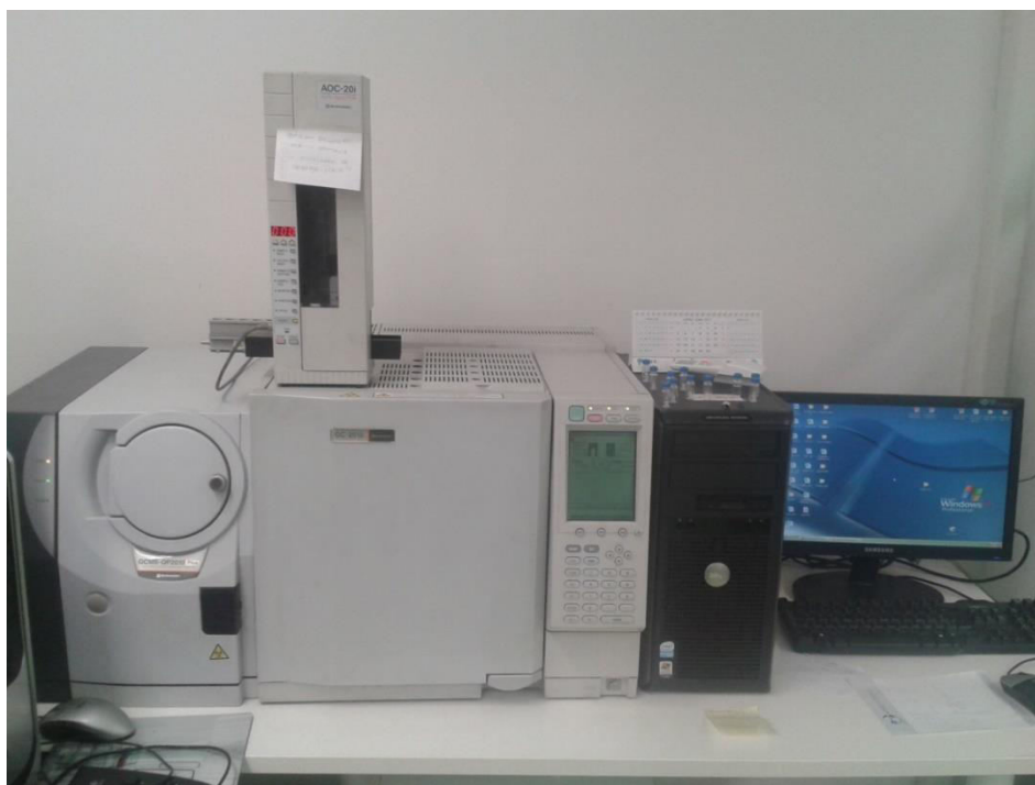
Slika 6. Vezni sustav plinski kromatograf-spektrometar masa GCMS-QP2010 Plus, Shimadzu
