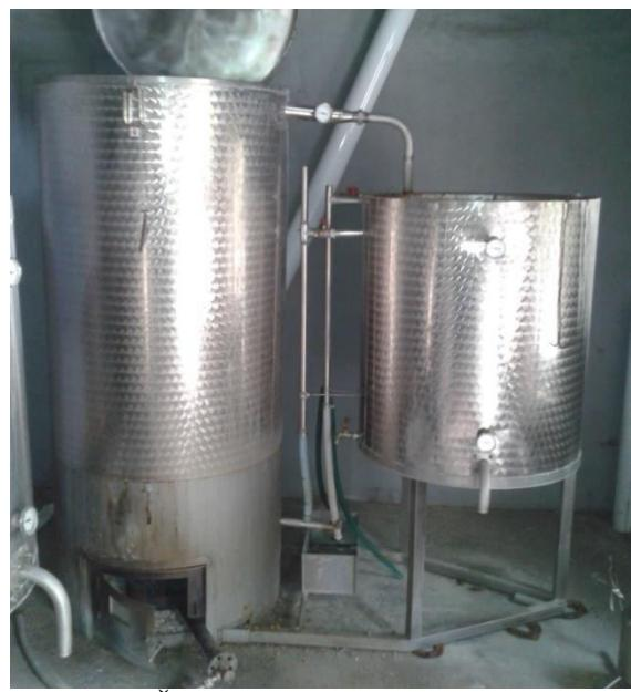
Slika 14. Šaržni destilator kapaciteta 510 L
