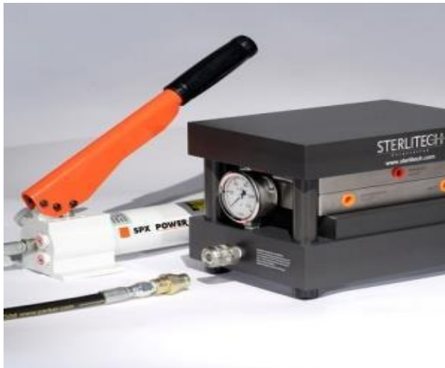
Slika 3.2. Membranska jedinica SEPA CF II umetnuta u nosač.
