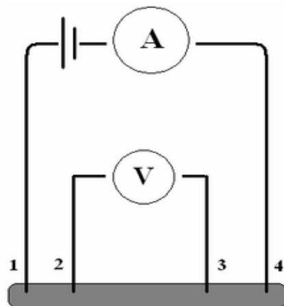
Slika 2.8. Shema mjerjenja elektrovodljivosti, metoda četiri točke
