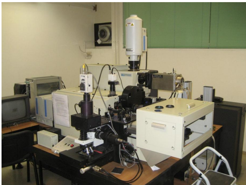
Slika 12. Ramanov spektrometar Jobin-Yvon T64000 [28]
