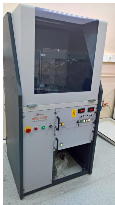
Slika 10. Rendgenski difraktometar praha APD2000.
