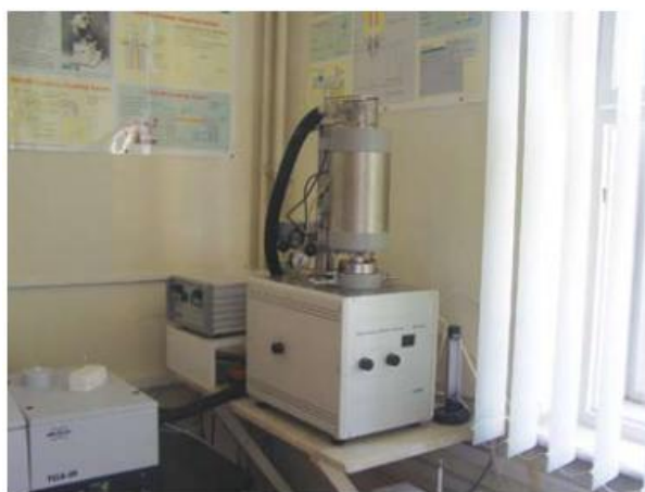
Slika 13. Instrument NETZSCH STA 409 [29]
