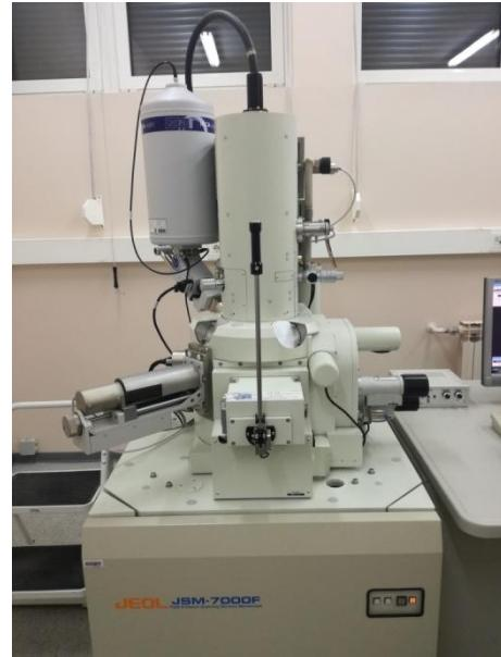
**Slika 14.** Pretražni elektronski miskroskop Joel JSM-7000F
