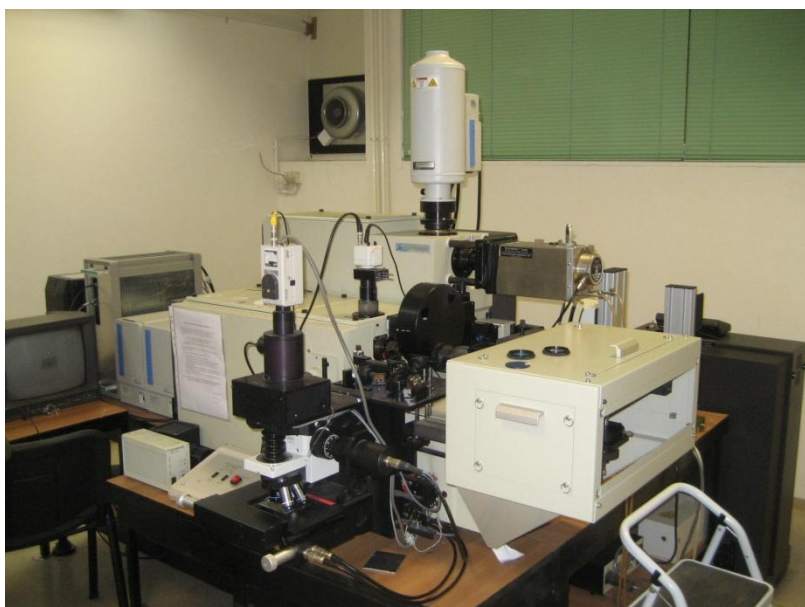
Slika 12. Ramanov spektrometar Jobin-Yvon T64000 [28]
