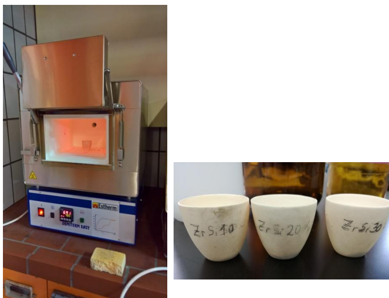
Slika 9. Peć za žarenje i porculanski lončići
