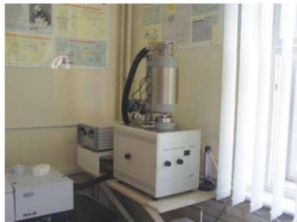
**Slika 13.** Instrument NETZSCH STA 409 [29]
