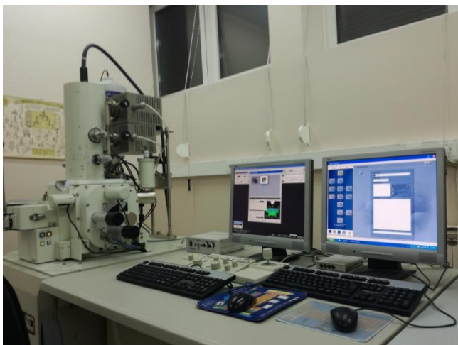
Slika 14. Pretražni elektronski mikroskop Joel JSM-7000F
