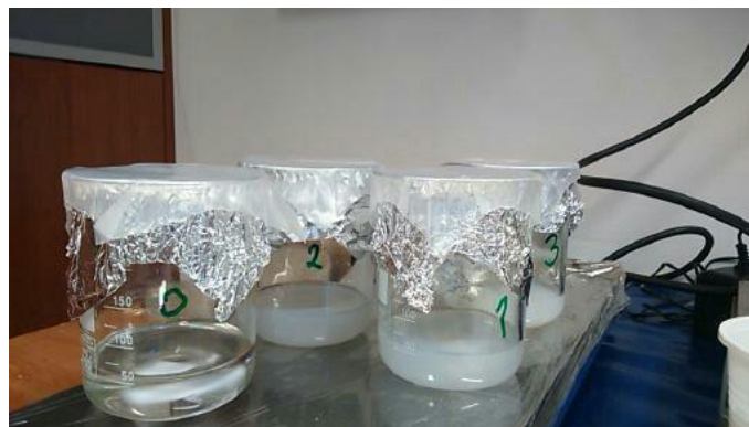
Slika 6. Zamiješavanje kompozita PCL/ZnO u kloroformu na magnetskoj miješalici (RuVe, Kika-WERKE__RO 10 Power)
