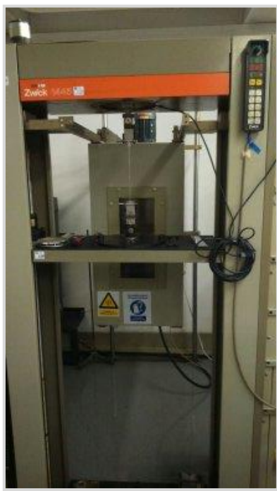
Slika 13. Uređaj za mjerenje čvrstoće, Zwick 1445
