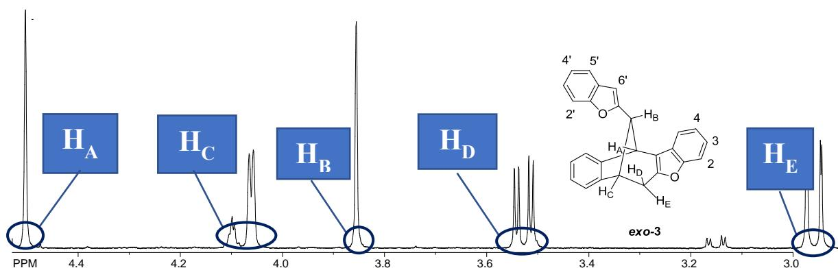
**Slika 6.** Alifatski dio  $^1\text{H}$  NMR spektra fotoprodukta **exo-3** (600 MHz) u  $\text{CDCl}_3$
