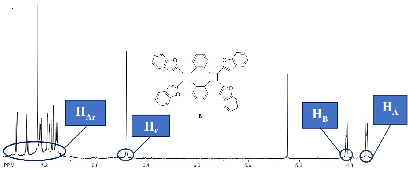
**Slika 14.**  ${}^1\text{H}$  NMR spekar dimernog fotoprodukta **6** (600 MHz) u  $\text{CDCl}_3$
