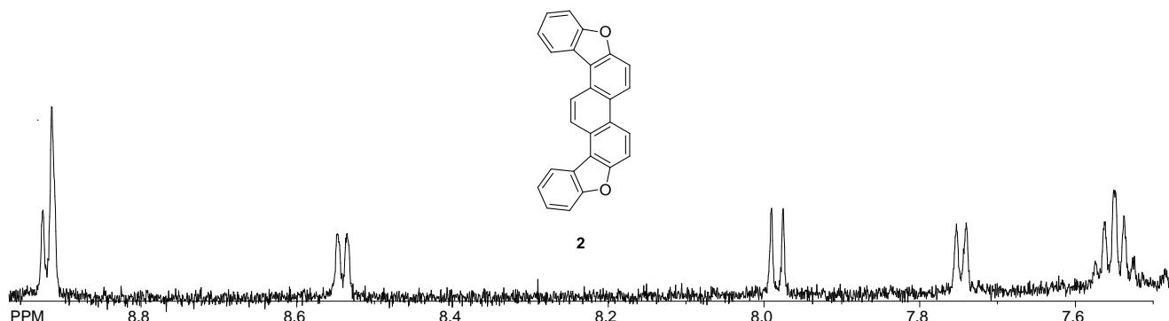
**Slika 5.** Aromatski dio  $^1\text{H}$  NMR spektra fotoprodukta **2** (600 MHz) u  $\text{CDCl}_3$
