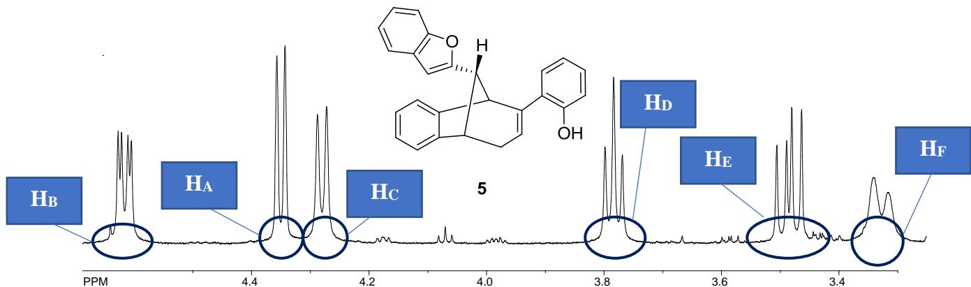
**Slika 11.** Alifatski dio  $^1\text{H}$  NMR spektra fotoprodukta **5** (600 MHz) u  $\text{CDCl}_3$
