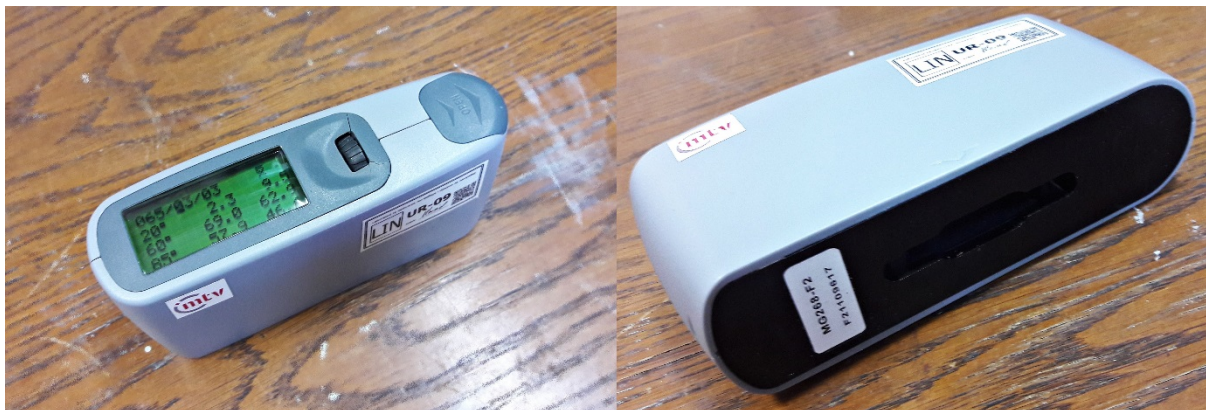
Slika 15. Uređaj za mjerenje sjaja tvrtke KSJ
