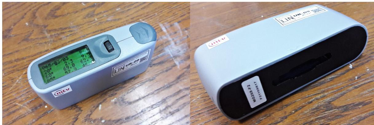
**Slika 15.** Uređaj za mjerjenje sjaja tvrtke KSJ
