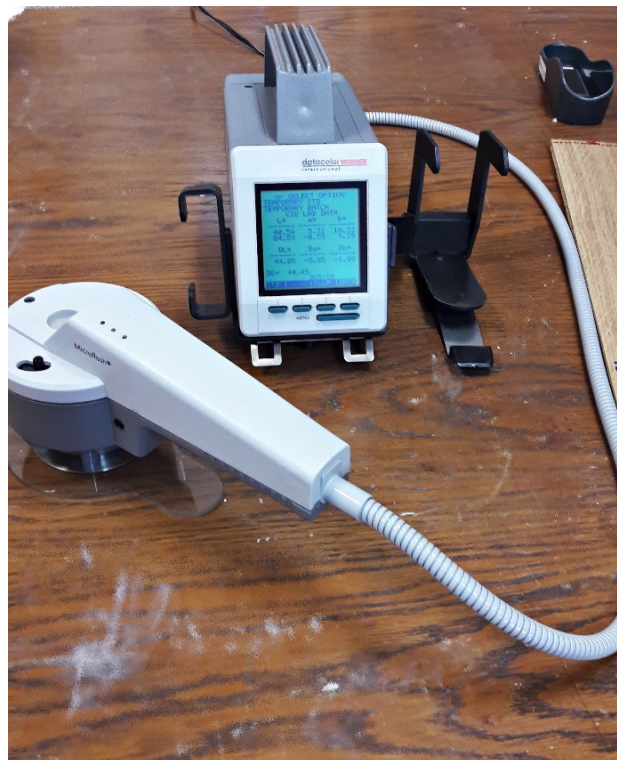
Slika 14. Spektralni fotometar Microflash 100d Datacolor
