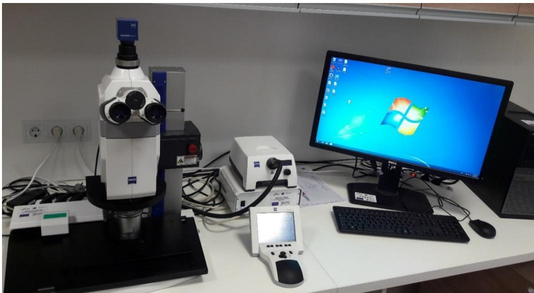
**Slika 14.** Optički mikroskop Axio Zoom.V16
