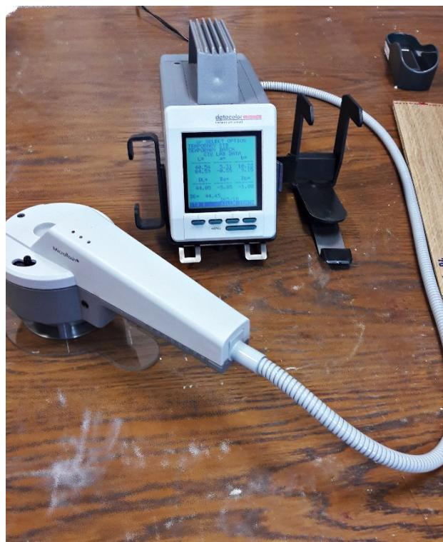
Slika 14. Spektralni fotometar Microflash 100d Datacolor
