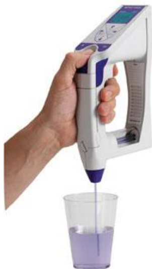
Slika 26: Uređaj za mjerenje gustoće kapljevine - METTLER TOLEDO Densito 30PX
