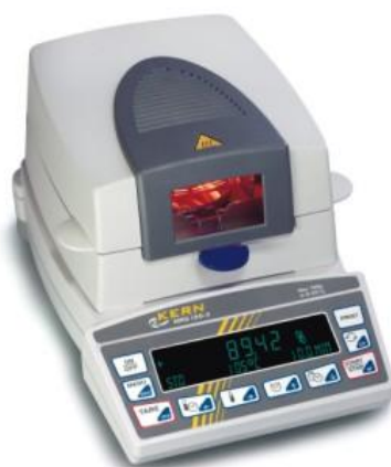
Slika 28. Infracrveni sušionik KERN MLS-C
