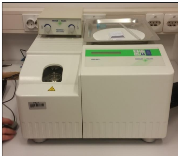
Slika 19. Diferencijalni pretražni kalorimetar Mettler toledo DSC 823 e
