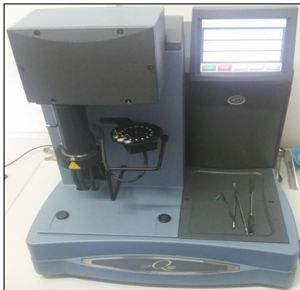
Slika 21. TGA uređaj tvrtke TA Instruments
