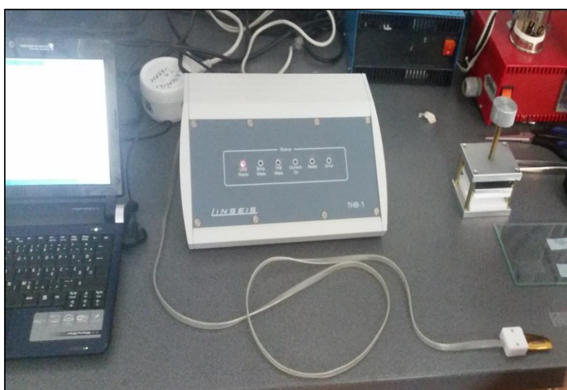
Slika 23. Uređaj za mjerenje toplinske vodljivosti tvrtke Linseis model THB-1
