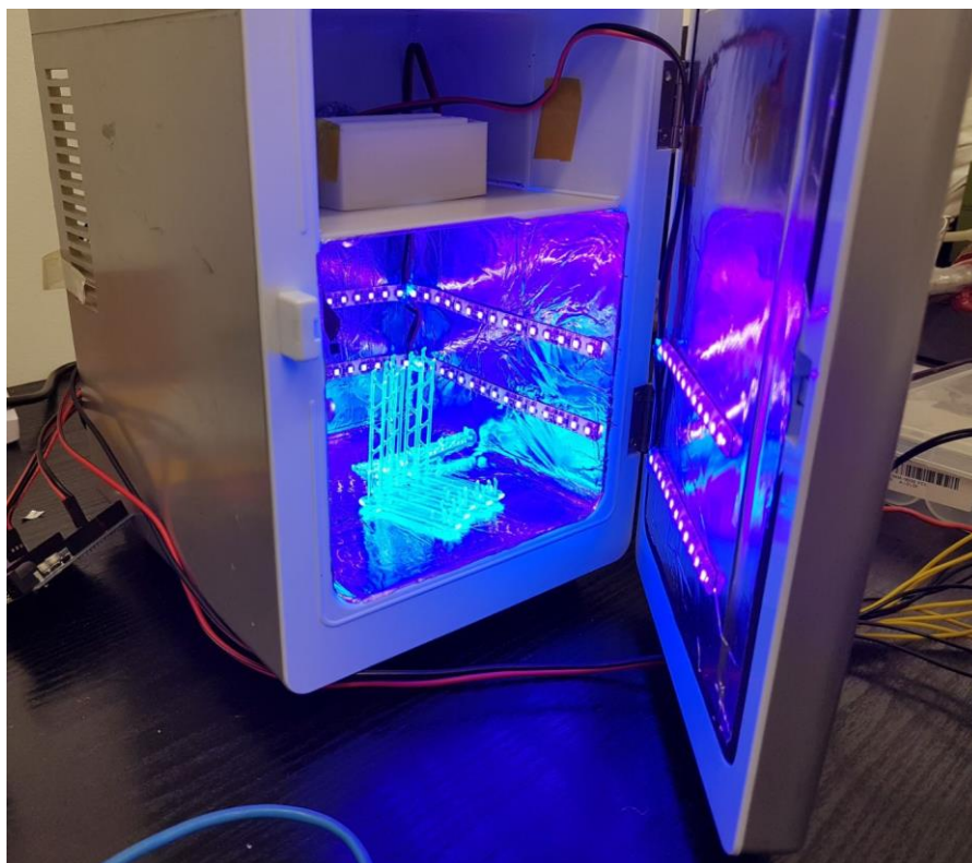
Slika 17. Samostalno izrađena komora opremljena LED svjetlom od 405 nm
