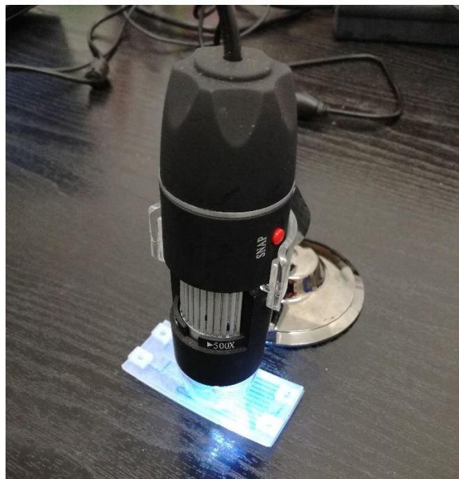
Slika 11. Određivanje širine kanala digitalnim mikroskopom
