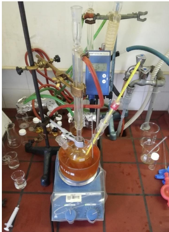
Slika 18. Sinteza biodizela u kotlastom reaktoru
