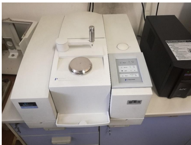
Slika 21. Infracrveni spektrofotometar s Fourierovom transformacijom signala PerkinElmer Spectrum One opremljen s ATR dodatkom
