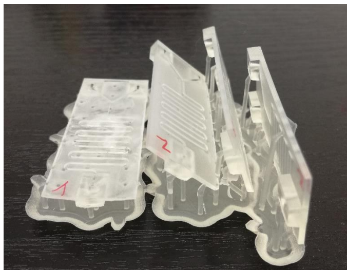
Slika 26. Mikroreaktori s otvorenim kanalima izrađeni pod različitim kutovima u odnosu na podlogu
