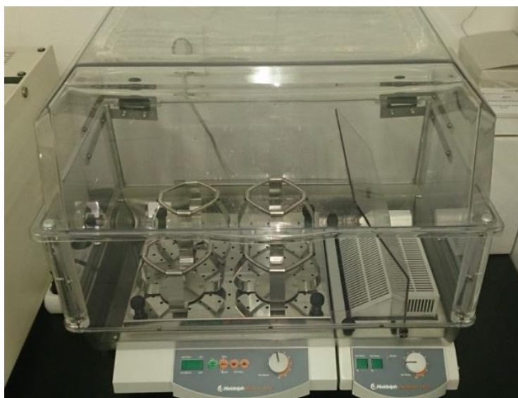
Slika 3.2. Rotacijska tresilica Unimax 1010, Heidolph – Inkubator 1000.
