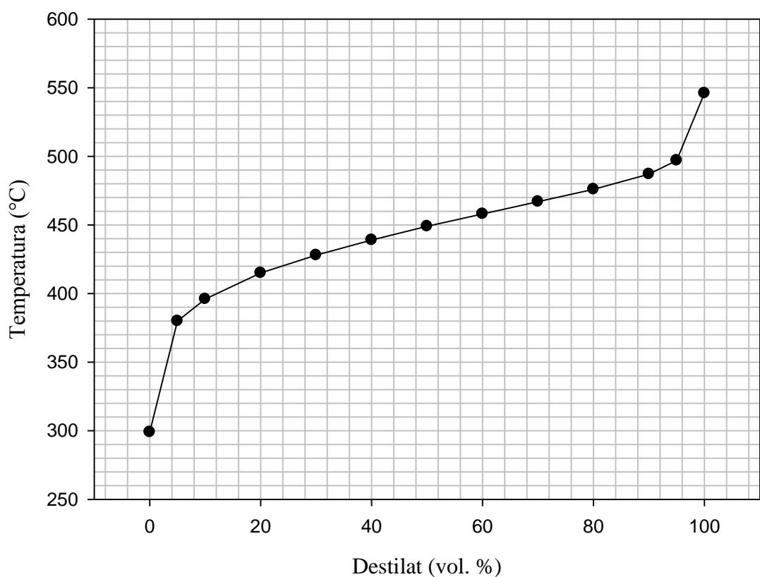
Slika 4.2.2.1. Simulirana destilacijska krivulja naftalana dobivena metodom ASTM D 2887.
