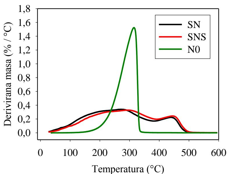
Slika 4.3.1.1. Ovisnost promjene mase (gore) i derivirane mase (dolje) o temperaturi navedenih uzoraka.
