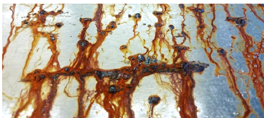
Slika 36. Korozija uzorka 2 nakon 29 dana u slanoj komori
