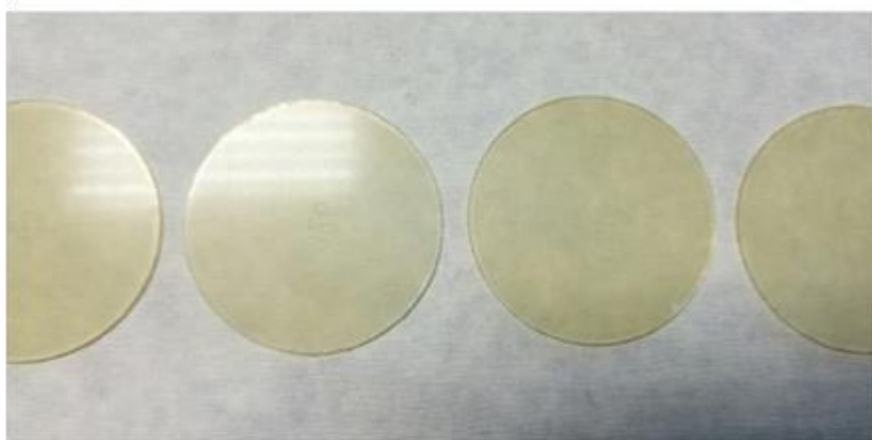
Slika 11. Pločice s imobiliziranim TiO 2 -SnS 2 filmom.
