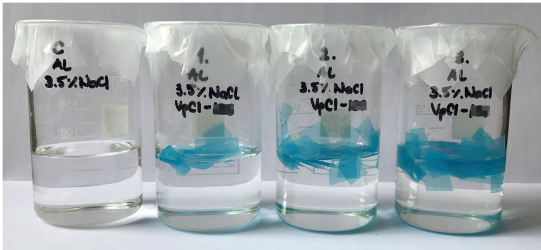
Slika 18. Pripremljene otopine s različitim koncentracijama inhibitora za nekontaktni test 2.
