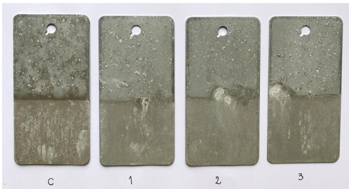
Slika 29. Osušene pločice nakon 7 dana izlaganja 3,5% otopini NaCl-a s različitim koncentracijama otopljenog VCI (1,2,3) i čistoj 3,5% otopini NaCl-a (C).
