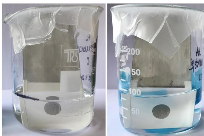
Slika 15. Pločice uronjene u neinhibiranu (lijevo) i inhibiranu (desno) 3,5% otopinu NaCl-a.
