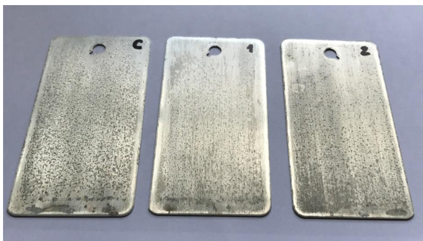
Slika 30. Osušene pločice nakon 10 dana izlaganja destiliranoj vodi u neinhibiranom sustavu (C), u sustavu s inhibitorom obloženim stijenkama posude (1) i sustavu s otopljenim inhibitorom (2).
