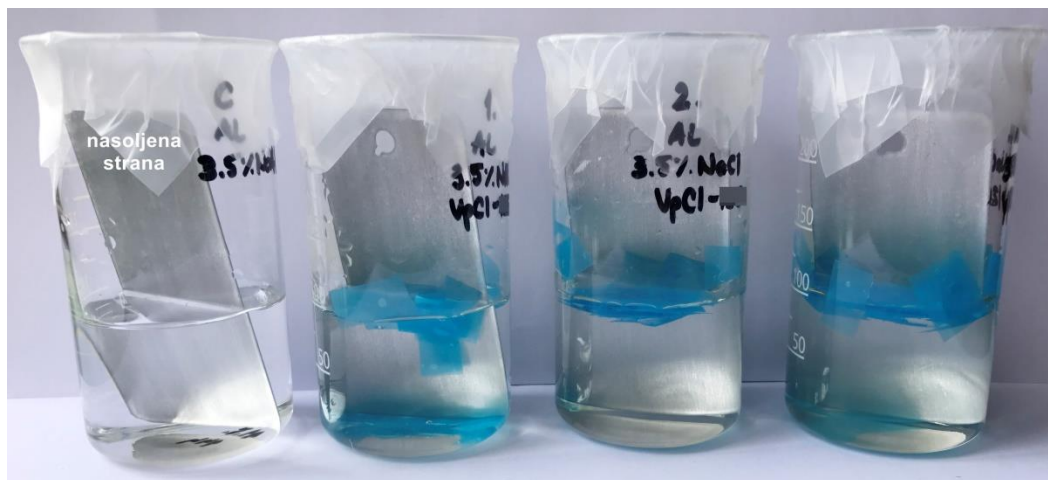
Slika 19. Izlaganje nasoljenih pločica 3,5% otopini NaCl-a s različitim koncentracijama otopljenog VCI i čistoj 3,5% otopini NaCl-a.
