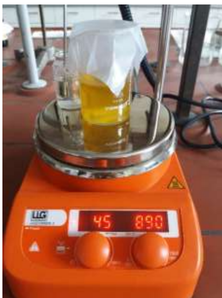
Slika 14. Prikaz miješanja 2%-tne otopine kitozana na magnetskoj miješalici.
