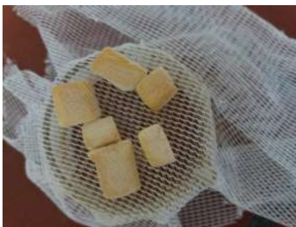
Slika 15. Prikaz kompozita Si1%-HA/CS.
