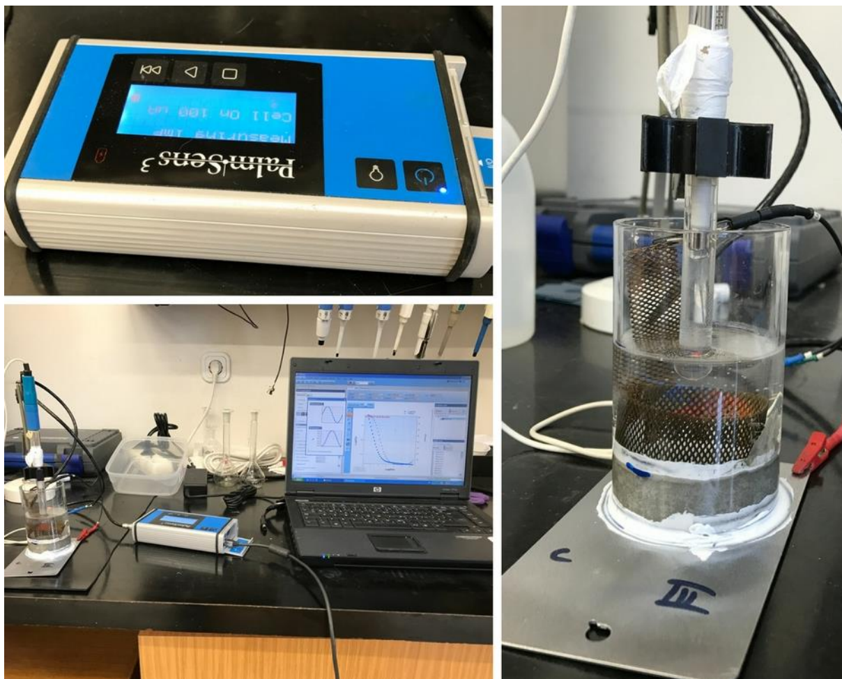
Slika 12. Provedba elektrokemijskih mjerenja
