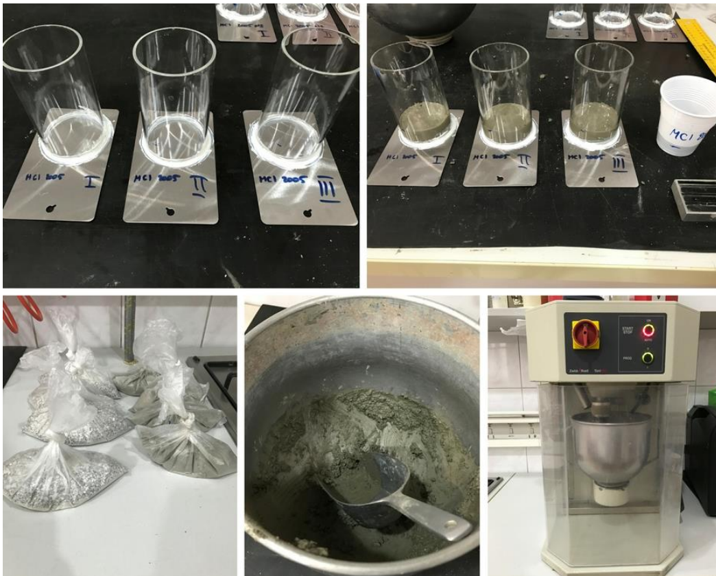
Slika 10. Miješanje morta za pripremu uzoraka
